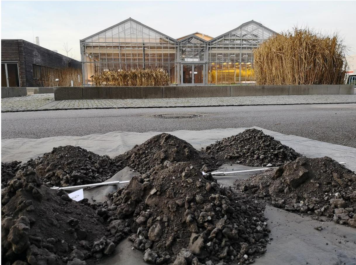
*Abbildung 7: Verschiedene Rostascheproben eines Biomasseheizwerks werden zur repräsentativen Probenahme vermischt. Im Gewächshaus des TFZ wird anschließend die Düngewirkung der Rostaschen auf verschiedene Kulturen untersucht*
