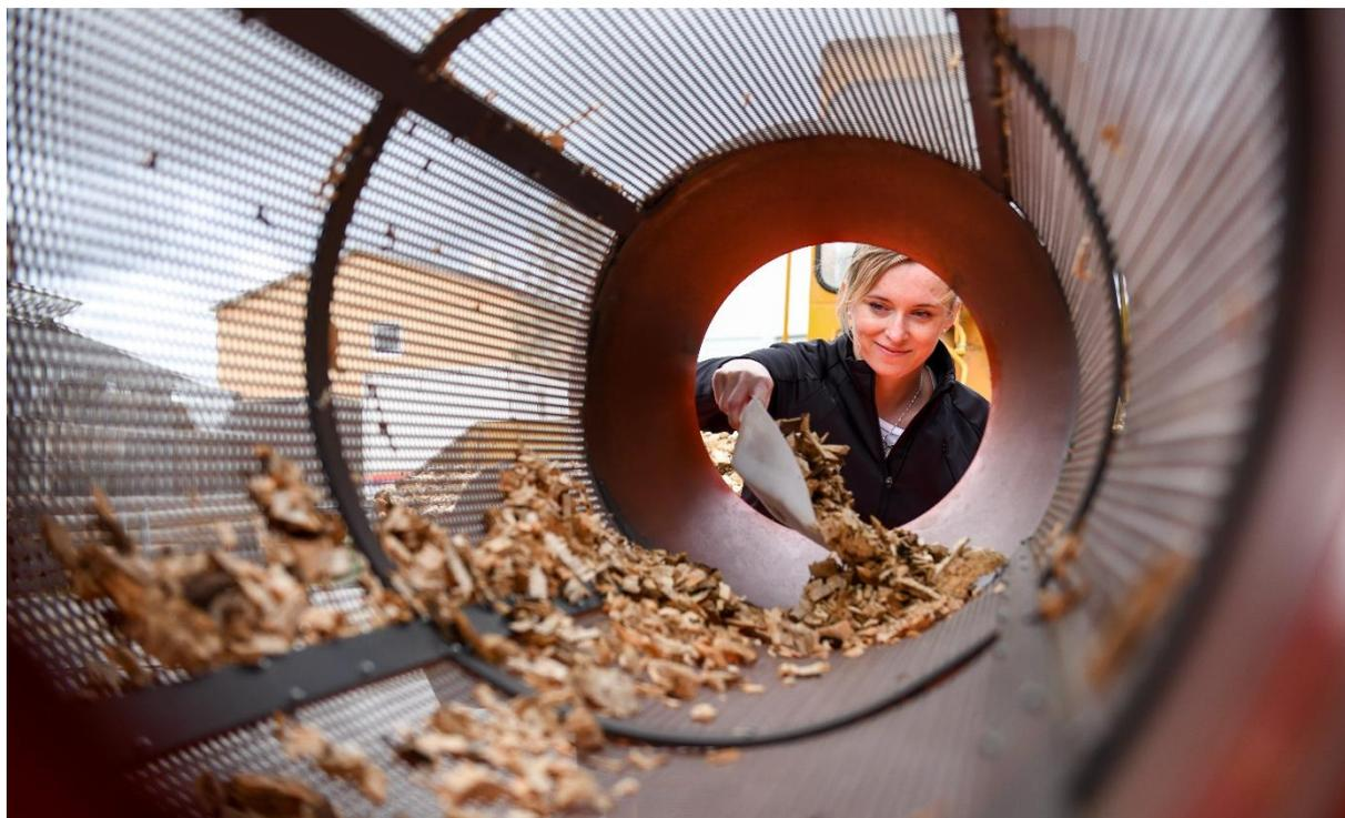
*Abbildung 6: Hackschnitzel werden mittels Trommelsiebung auf ihren mineralischen Verschmutzungsgrad hin untersucht. Ziel des Projekts Quasi-Holz ist es, die Verunreinigung von Holzbrennstoffen zu verringern und die Verbrennung von Holzbrennstoffen zu verbessern (Bild: Tobias Hase)*
