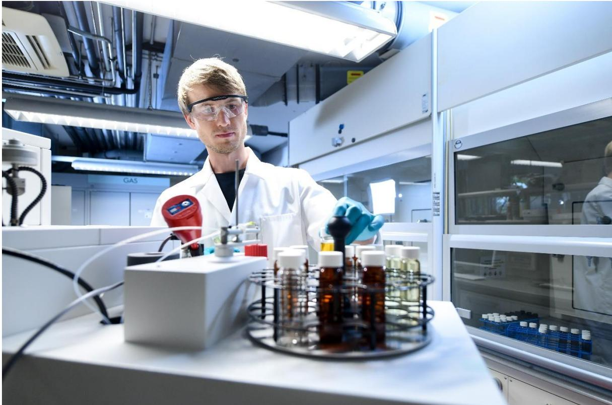
Abbildung 8: Rapsölkraftstoff wird mittels des Messgeräts AFIDA hinsichtlich seines Zünd- und Verbrennungsverhaltens analysiert. Damit kann das Einspritzverhalten eines Motors besser auf den Kraftstoff abgestimmt und so ein effizienter und emissionsarmer Betrieb gewährleistet werden. Bild: Tobias Hase
