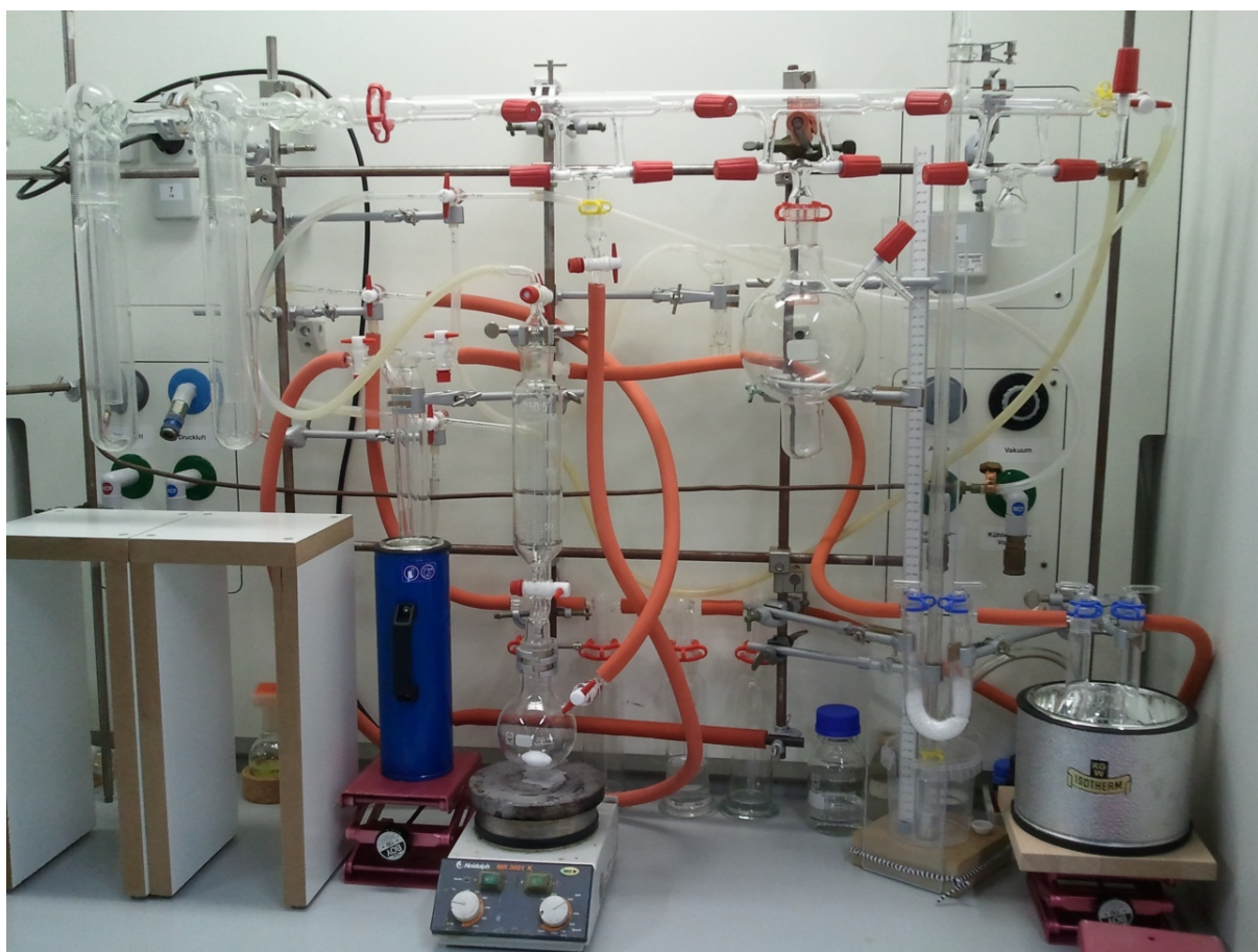
Abbildung 13: Apparatur zur Behandlung organischer Verbindungen mit Stickoxiden; links: Herstellung und Destillation der Stickoxide, rechts: Gasreinigung und Kolben für die Umsetzung
