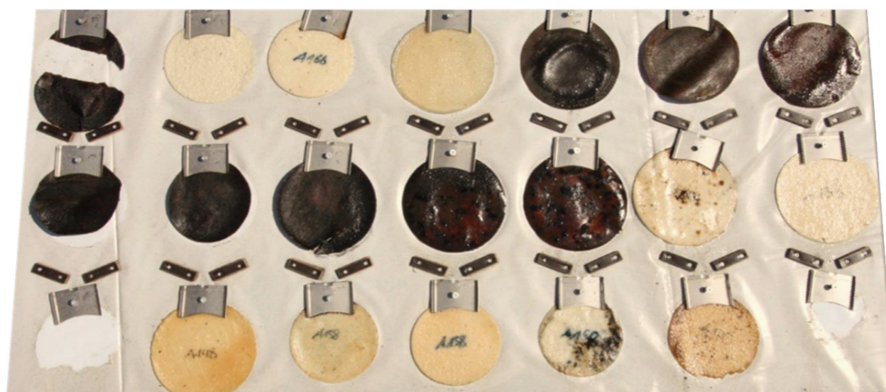
Abbildung 49: Probekörper (V187) nach sechsmonatiger Außenlagerung
