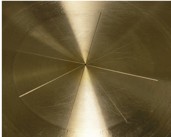
Abbildung 18: Gasdurchlässigkeitsprüfung (GDP): Auflagefläche der Probe, Zellen-Unterteil App. 2
