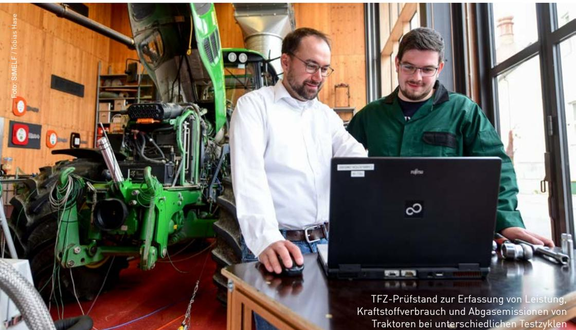
TFZ-Prüfstand zur Erfassung von Leistung, Kraftstoffverbrauch und Abgasemissionen von Traktoren bei unterschiedlichen Testzyklen
