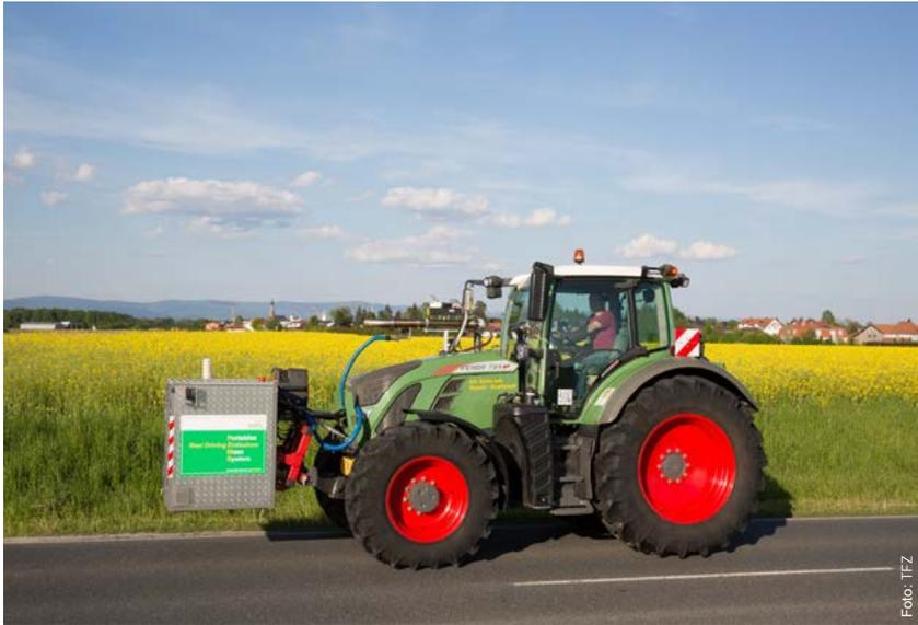
hen Wirksamkeit der katalytischen Abgasnachbehandlung im realen Betrieb. Auch die  $\text{NO}_x$ -Emissionen liegen bei den realen Arbeiten des Traktors unterhalb der gesetzlichen Grenzwerte am Prüfstand.
