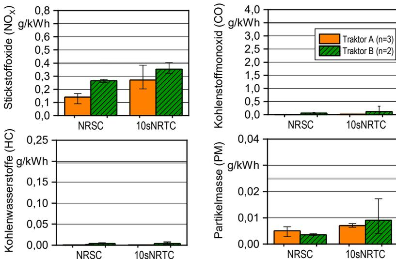
Die Messung der Abgasemissionen am TFZ-Traktoren-Prüfstand weisen darauf hin, dass mit Rapsölkraftstoff die Grenzwerte der Abgasstufe IV (NO<sub>x</sub>: 0,4 g/kWh, CO: 3,5 g/kWh, HC: 0,19 g/kWh und PM: 0,025 g/kWh) deutlich unterschritten werden können.
