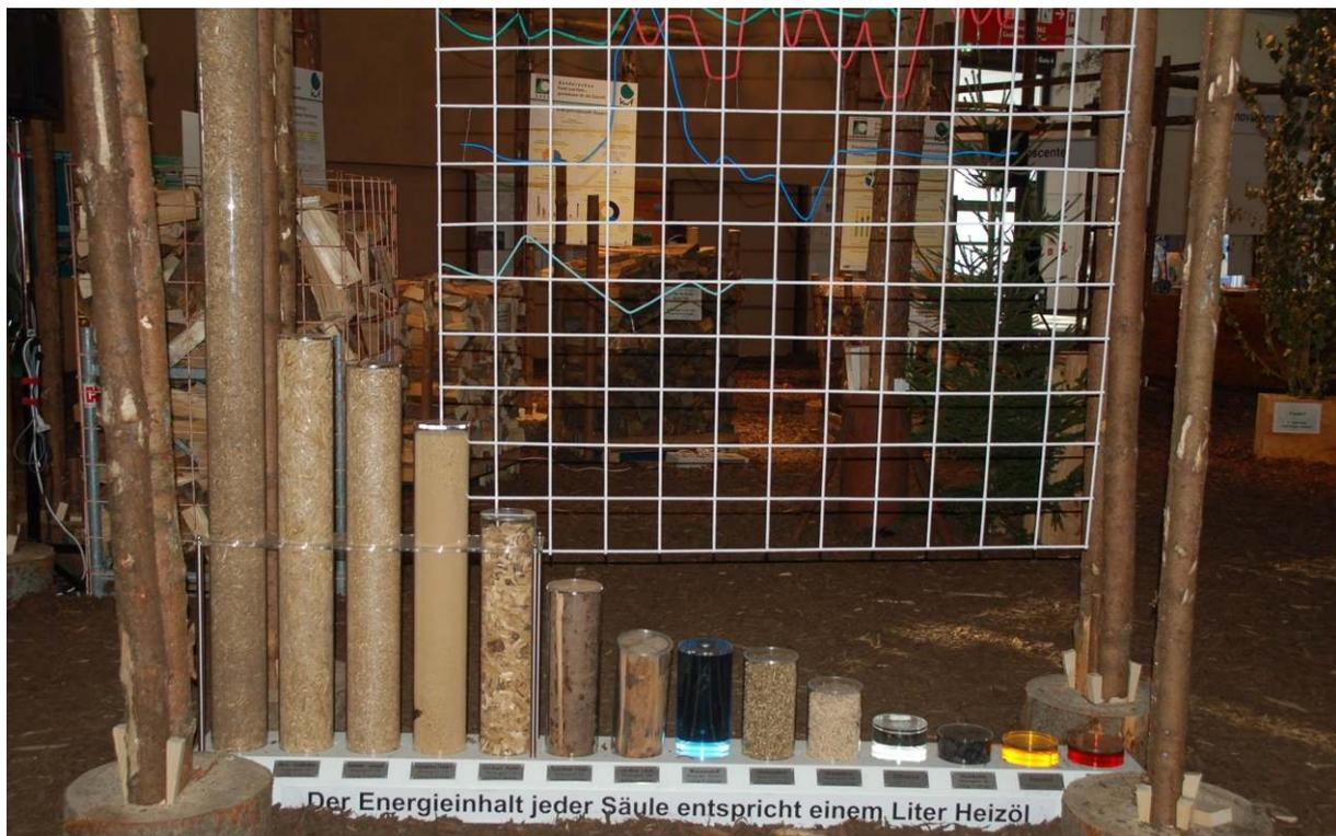
Abbildung 25: Die Brennstofforgel des TFZ zeigt die Energieinhalte verschiedener Energieträger im Vergleich zu Heizöl
