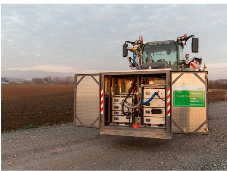
Portables Emissionsmesssystem „PEMS“ zur Messung der Abgase eines pflanzenölkraftstofftauglichen Traktors Fendt 724 im realen Betrieb.
