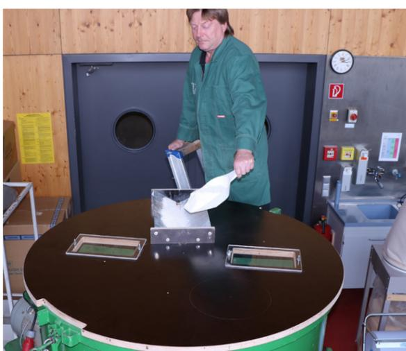
**Manuelle Zudosierung von Kaolin zum gemahlene Brennstoff. Aus der Mischung werden in der eigenen Anlage Pellets hergestellt und auf die Brennstoffeigenschaften getestet.**
