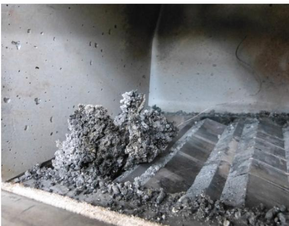
**Die Asche „schwieriger“ Brennstoffe wie Sonnenblumenschalen, Gras oder Stroh zeichnen sich durch einen niedrigen Ascheschmelzpunkt aus. Es kommt zur gefährdeten Schlackebildung. Das TFZ arbeitet im Projekt BIOFLEX! an verbesserten Brennstoffzusammensetzungen um dieses Problem zu lösen.**
