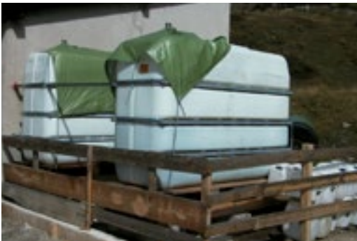
Falsche Lagerung von Rapsöl: Direkte Sonneneinstrahlung führt zu vorzeitigem Qualitäts- verlust.
