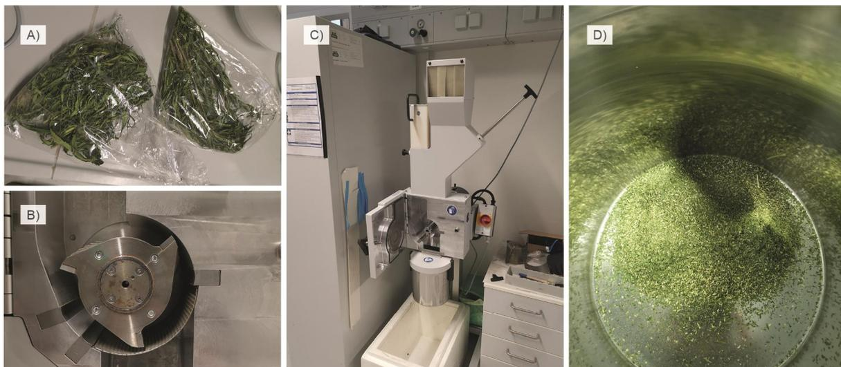
*Abbildung 65: Getrocknete Proben in Crisp Bags (A); Schneidwerkzeug (B); Schneidmühle Fritsch SM 100 (C); gemahlene Probenmaterial  $< 1$  mm (D)*
