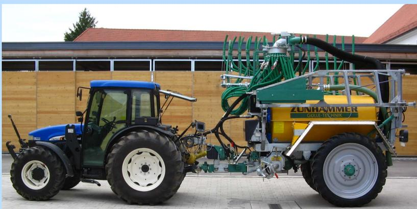
Abb. 2: Parzellengüllefass mit Schleppschräuchen des TFZ mit computergesteuerter Gärrestausrbringung
