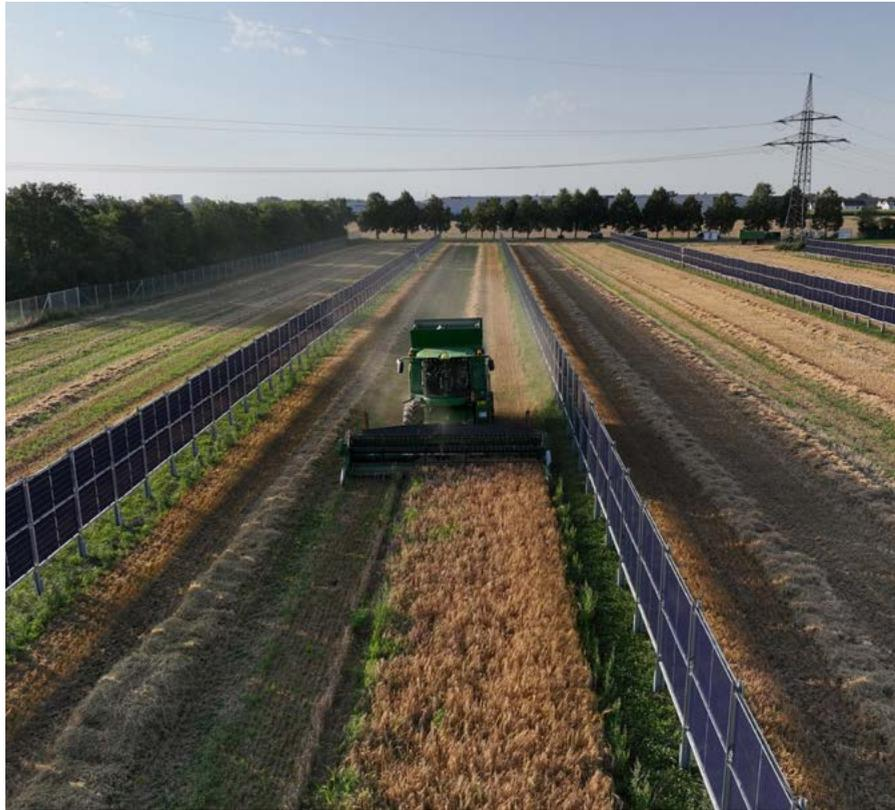
Vertikale Agri-PV-Anlage mit bifazialen Modulen bei der Ernte in Grub
