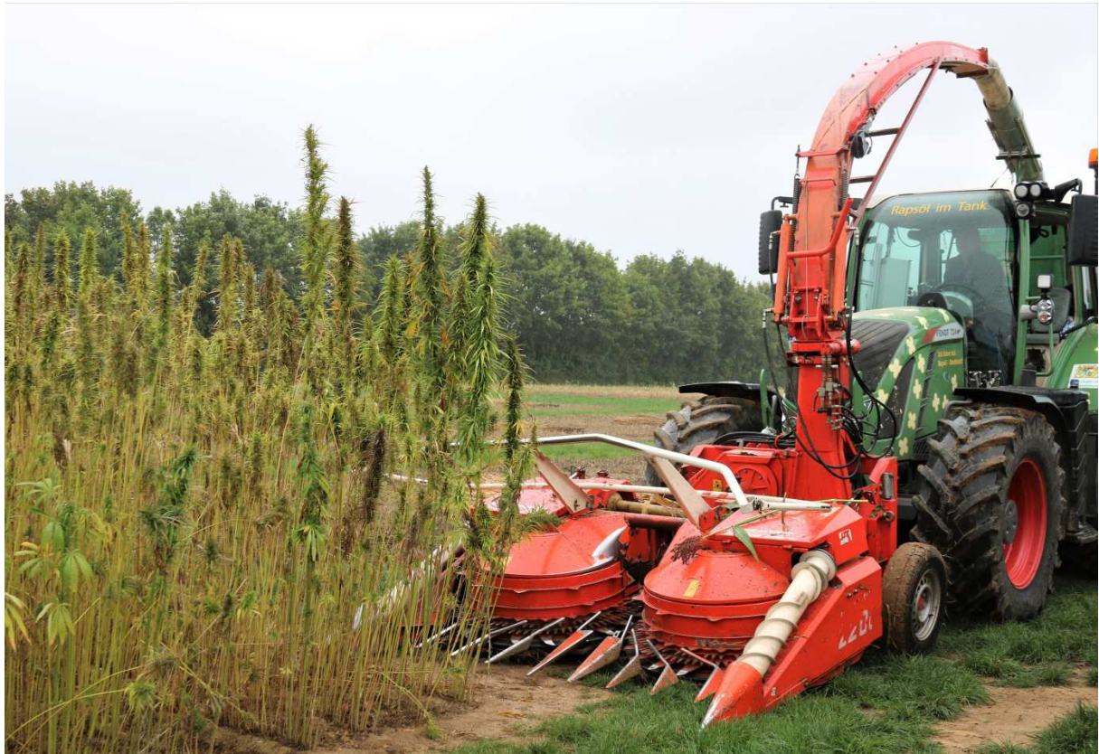
Abbildung 3: Ernte mit dem Parzellenhäcksler
