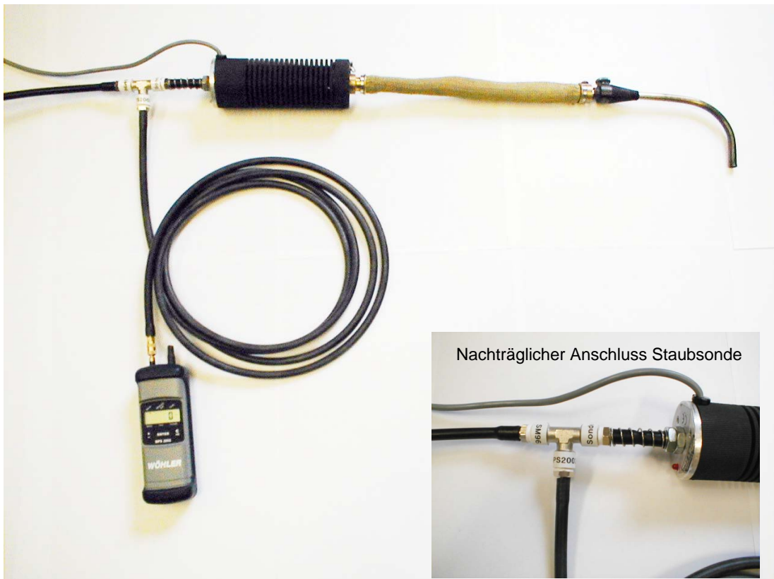
Abb. 3 Messgerät DPS-2002 für die Bestimmung des Differenzdrucks bei der Staubmessung, messtechnisches Prinzip (oben) und Realisierung (unten) durch technische Erweiterung an einem konventionellen Messgerät für Staubmessungen nach 1.BImSchV (Hersteller: Fa. Wöhler MGKG GmbH, Bad Wünnenberg) (nach /1/)
