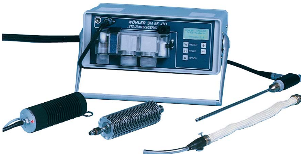
Abb. 2 Handelsübliches Messgerät zur Überprüfung der Staub- und CO-Emissionen nach 1. BImSchV (Wöhler SM 96-CO)
