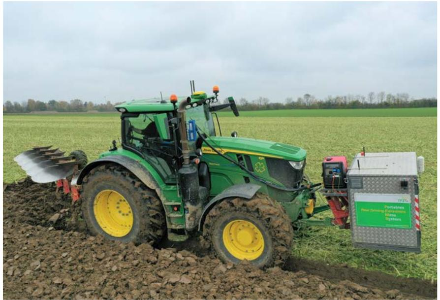
Bild 1: Rapsöltraktor 6R 215 während der Abgasmessung beim Pflügen mit einem portablen Emissions-Messsystem (PEMS) im Frontanbau, das gleichzeitig der Ballastierung dient (Fotos: TFZ)
