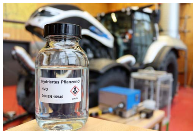
■ Bild: Untersuchung von HVO-betriebenen Traktoren am Prüfstand des TFZ zeigen gute Ergebnisse bezüglich Abgasverhalten und Motorleistung (Foto: TFZ)
