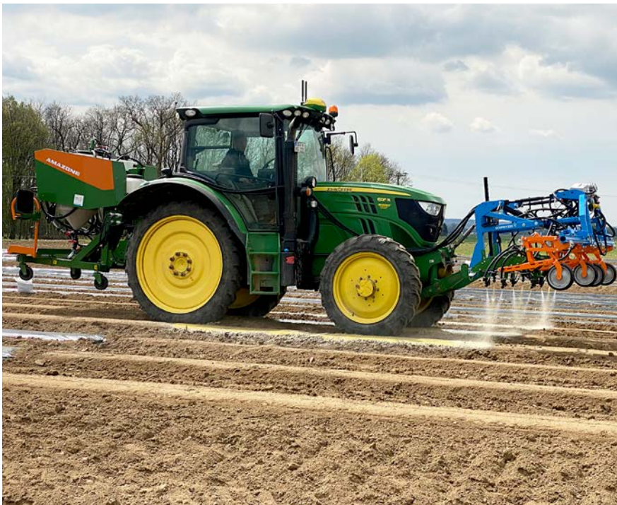
■ Bild 1: Ausbringung des Mulchmaterials mit dem Geräteprototyp der Firma Amazonen-Werke im Einlegegurkenanbau (Foto: Lisa Steinhuber, TFZ)
