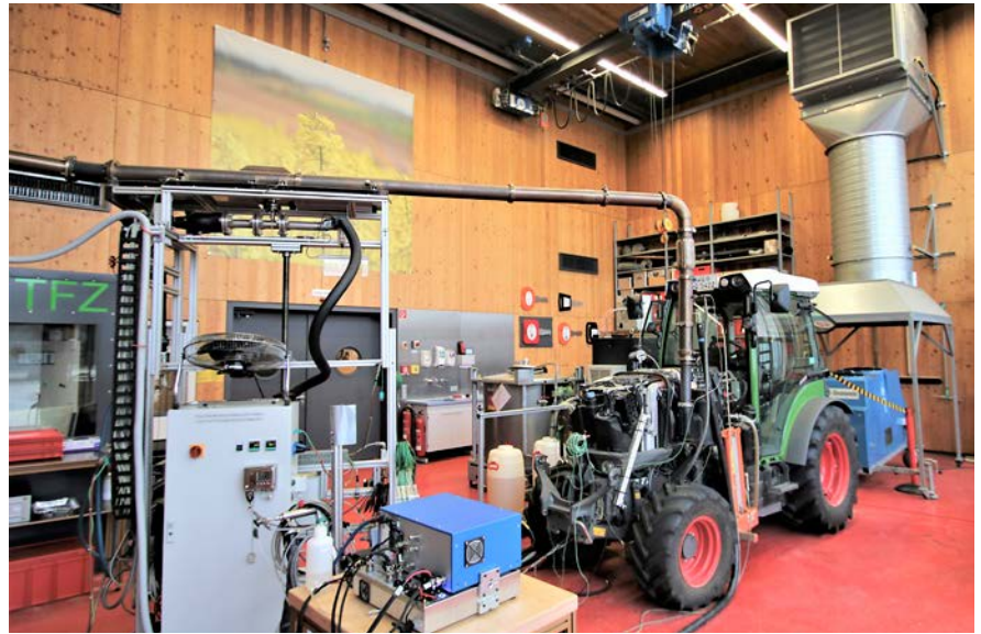
■ Bild 1: Traktorenprüfstand zur Leistungs- und Emissionsmessung am TFZ (Fotos: TFZ)
