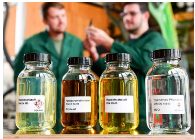
Bild 1: Diesel, Biodiesel, Rapsölkraftstoff und Paraffinischer Diesel (HVO) für Leistungs- und Abgasmessungen am Traktorenprüfstand des Technologie- und Förderzentrums. (Bild: Tobias Haase, StMELF)
