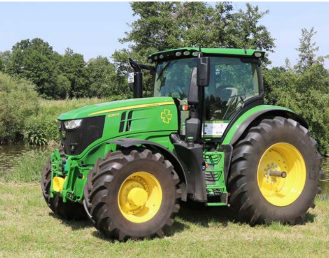
Bild 2: TFZ Multi-Fuel-Forschungs-Traktor John Deere 6250 R der Abgasstufe 5 für Rapsölkraftstoff, Biodiesel und Dieselmotoren im Einsatz auf den Bayerischen Staatsgütern (Foto: TFZ)
