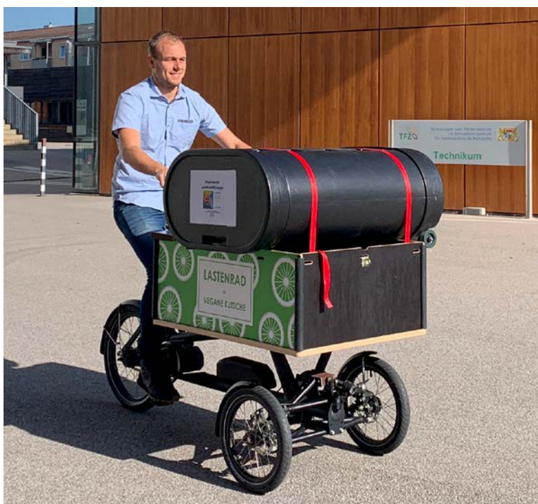
▣ Bild 2: Das LSE-Lasterad wird von den Mitarbeitern des Beratungsteams LandSchaftEnergie gerne genutzt. Die Neigetechnik verleiht dem Trike das komfortable Fahrgefühl eines Zweirades (Foto: Rita Haas)
