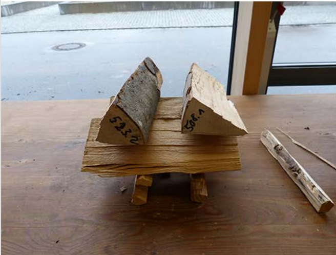
Bild 2: Beispiel zweier untersuchter Anzündvarianten (Zündstapel) (Foto: Robert Mack)
