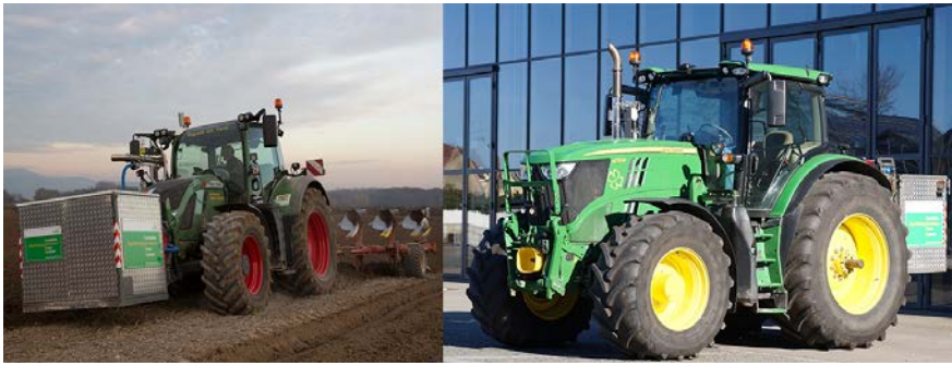
Bild 2: Portable Emissionsmesssysteme im Frontanbau beim Pflügen am Fendt Vario 724 S4 (links) und beim Straßentransport im Heckanbau am John Deere 6215R (rechts)
