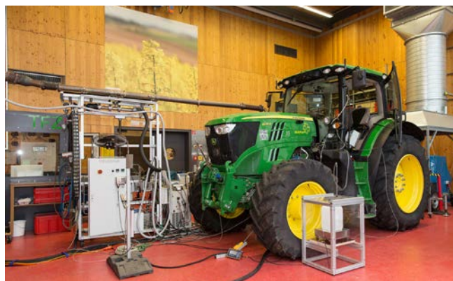
Bild 1: Traktorenprüfstand zur Leistungs- und Emissionsmessung mit Rapsöl- und Dieselmotoren (alle Fotos: TFZ)
