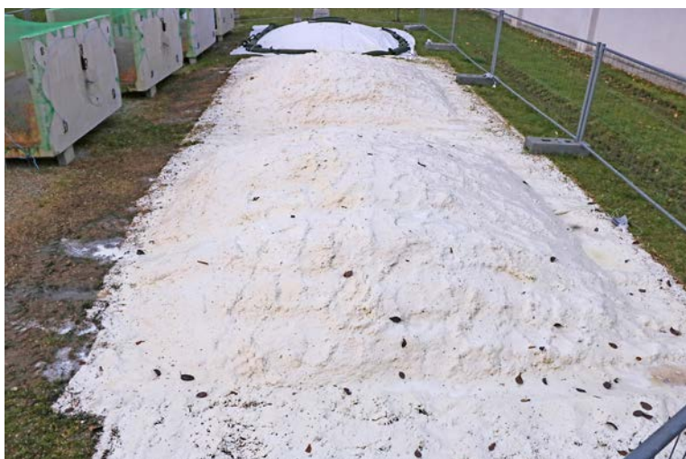
▣ Bild 2: Blick auf zwei Freigärhaufen mit der optimierten Silageabdeckung einen Monat nach Versuchsbeginn – hinten im Bild: Referenz mit Folienabdeckung (Foto: Veronika Schreieder, TFZ)
