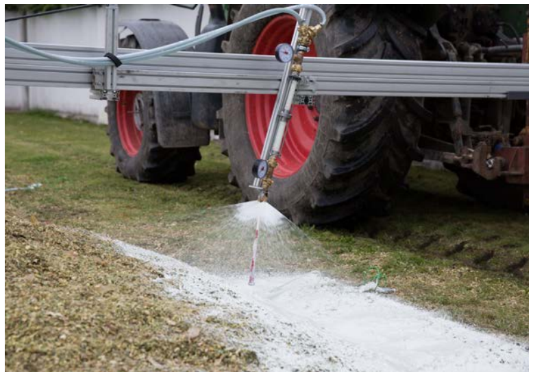
Bild 1: Applikation des neuartigen Abdeckmaterials auf einen Freigärhaufen mit einer in ihrer Neigung verstellbaren Spritzlanze auf einem höhenverstellbaren Spritzbalken im Heckaufbau eines Traktors (Foto: Ulrich Eidenschink, TFZ)
