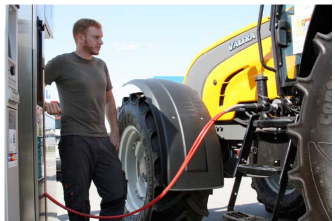
▭ Bild 3: Betankung des Biomethan Traktors. (Foto: Dr. Klaus Thuneke, TFZ)
