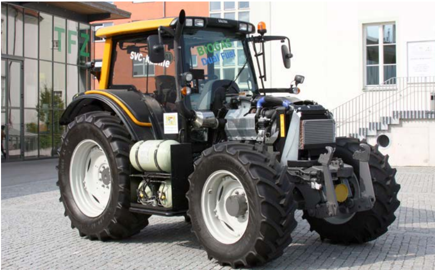
▭ Bild 2: Valtra N101 Hi Tech (Dual-Fuel-Traktor) mit abmontierter Verkleidung der Gastanks. (Foto: Peter Emberger, TFZ)
