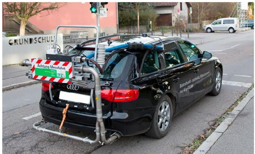
Bild 1: Flexible-Fuel-Vehicle mit portablen Emissionsmesssystem (Foto: TFZ).
