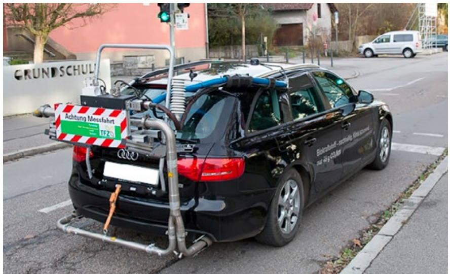
Bild 1: Flexible-Fuel-Vehicle mit portablen Emissionsmesssystem (Foto: TFZ).
