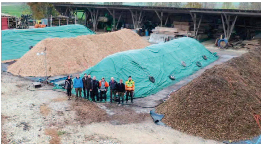
▣ Bild 2: Lagerungsversuche mit zwei Energierundholz mieten (links) und zwei Waldrestholz mieten (rechts), jeweils abgedeckt und offen gelagert (Foto: Fabian Schulmeyer, LWF)
