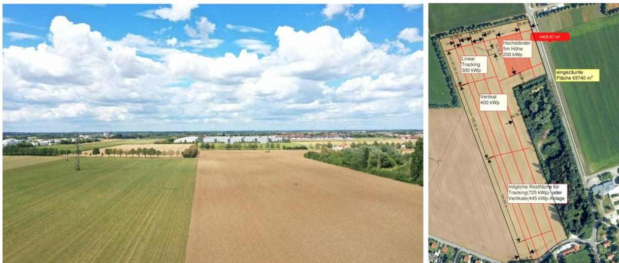
Abbildung 12: Links: Drohnenaufnahme der Projektfläche in Grub (rechts: Fläche für die Agri-PV-Anlage, links: Referenzfläche), rechts: aktueller Planungsstand der Agri-PV-Anlage
