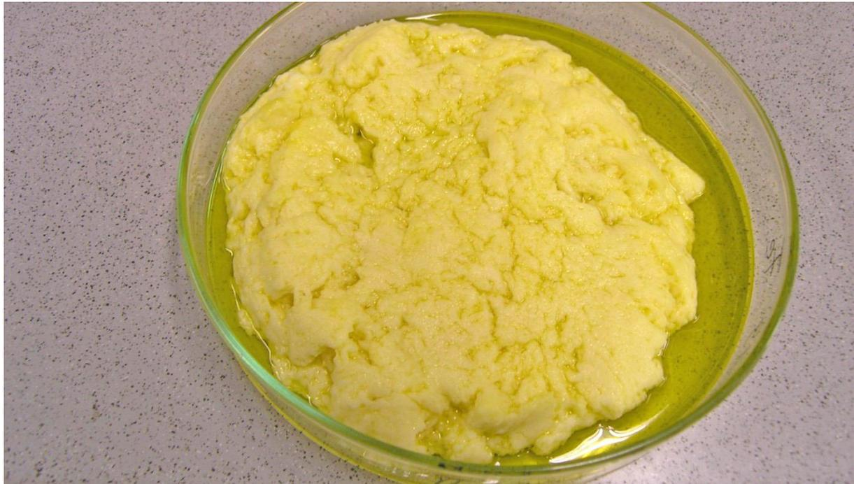
Abbildung 17: Zu schnell gelierende Mischung aufgrund zu großer Natriumalginat-Menge (R100)
