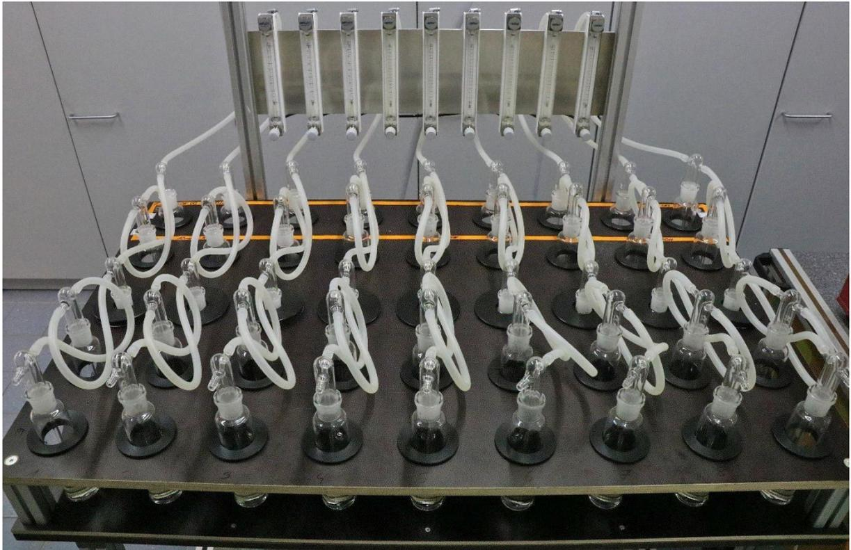
*Abbildung 3: Aufbau des Abbaubarkeitsversuchs mit drei Nullprobenkolben (links), drei Probenkolben (Mitte) und drei Referenzkolben (rechts)*
