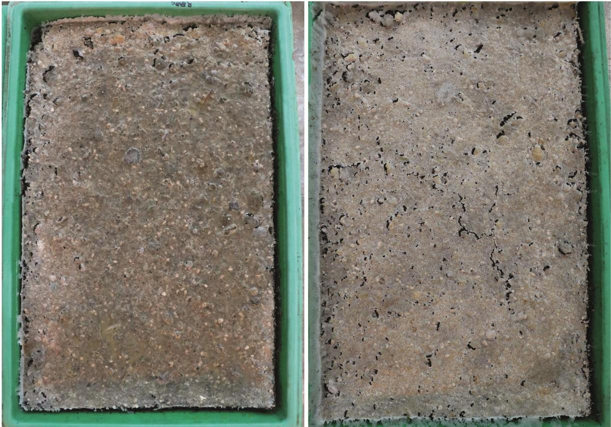
Abbildung 23: Vergleich zweier Rezepturen in einem praxisnahen Test zum Schrumpfungsverhalten (R114k links, R11f rechts)
