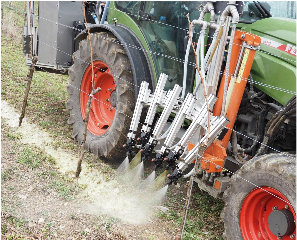
*Abbildung 46: Ausbringen des Mulchmaterials mit zwei Düsensystemen im Zwischenachsenbau des Schmalspurschleppers*
