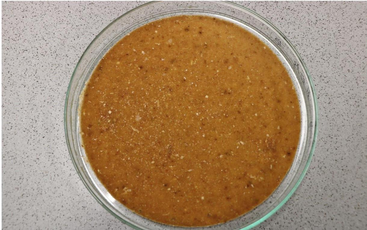
Abbildung 18: Rezeptur mit Sägemehl als Füllstoff (R109g)
