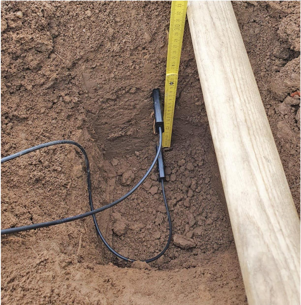
Abbildung 8: Platzieren der Sensoren zur Bestimmung der volumetrischen Bodenfeuchte in einer Tiefe von 15 cm bzw. 30 cm im Boden
