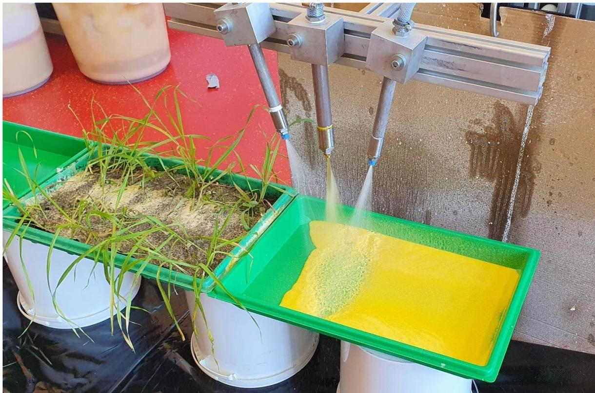
*Abbildung 43: Versuchsaufbau für das Vermischen im Sprühstrahl mit Flachstrahldüsen*
