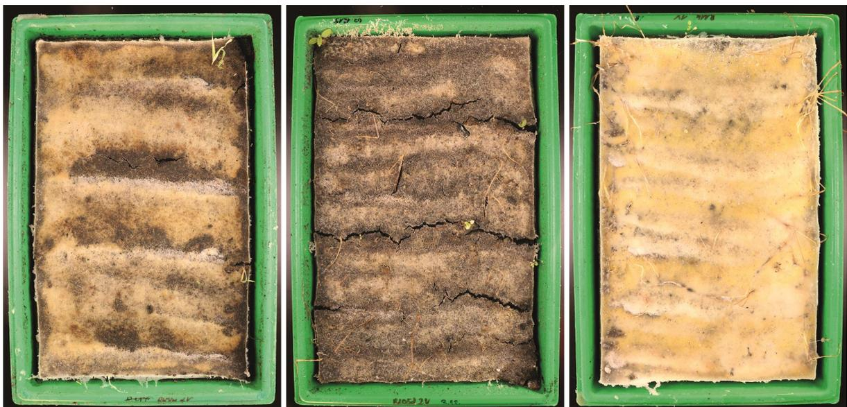
Abbildung 37: Vergleich der Oberflächenbeschaffenheit und Schrumpfung der Mulchmaterialien der drei Rezepturen R88a (links), R105d (Mitte) und R114k (rechts) drei Wochen nach der Applikation im Gewächshaus
