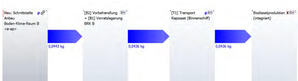
Abbildung 65: GaBi-Bilanzierungsmodell des Produktsystems der Rapsölmethylesterproduktion mit integrierter Biodieselanlage ab der Schnittstelle Anbau
