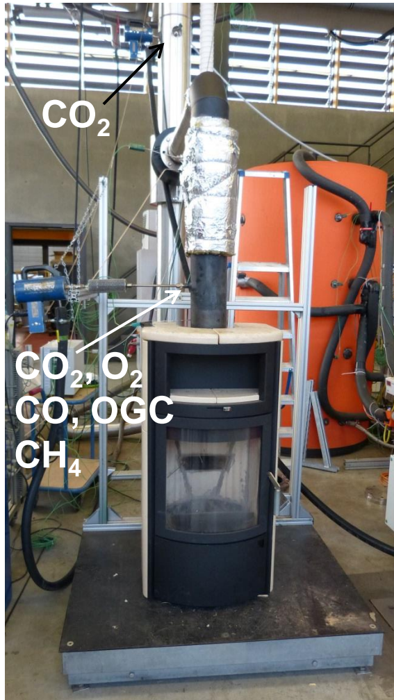
Prüfstands-aufbau und Anordnung der Messstellen.
