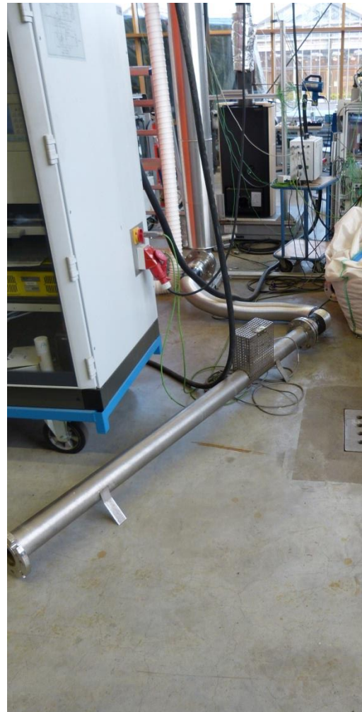
Messstelle Strömungsgeschwindigkeit am Zugbegrenzer.
