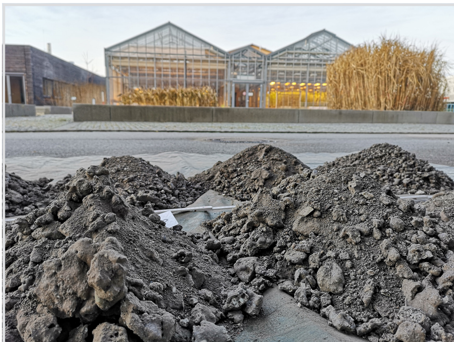
Bild 1. Probenahme von Rost- und Kesselasche nach LAGA PN 98 [20].
