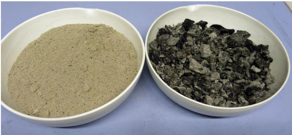
Abbildung 43: Gesiebte Rückstände nach 8 Abbränden mit Steuerung Schmid SMR. Links: Partikel  $\leq 3,15$  mm, rechts: Partikel  $> 3,15$  mm
