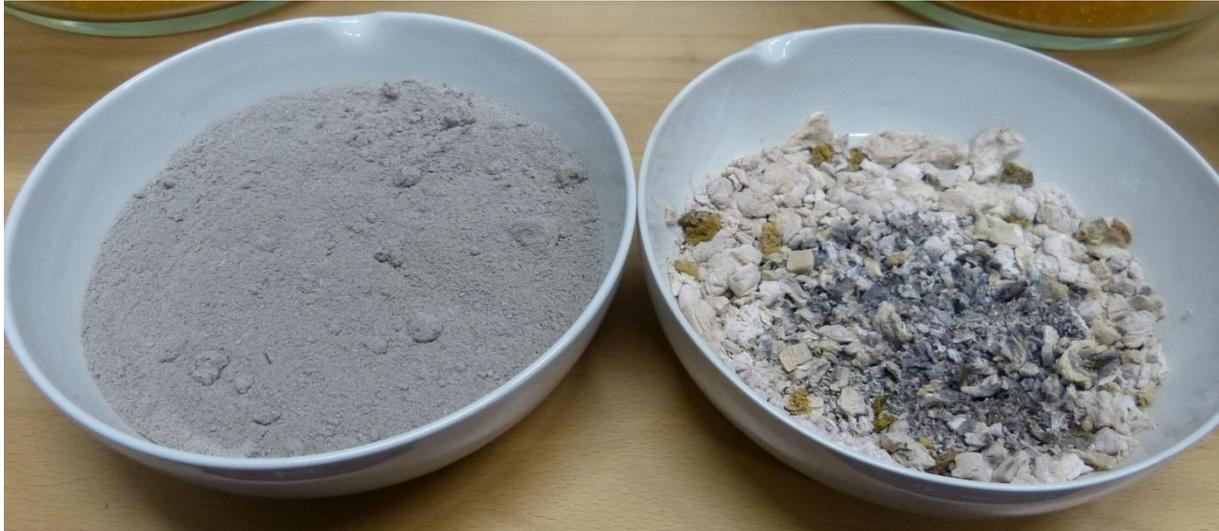
Abbildung 42: Gesiebte Rückstände nach 8 Abbränden bei manuellem Betrieb. Links: Partikel  $\leq 3,15$  mm, rechts: Partikel  $> 3,15$  mm
