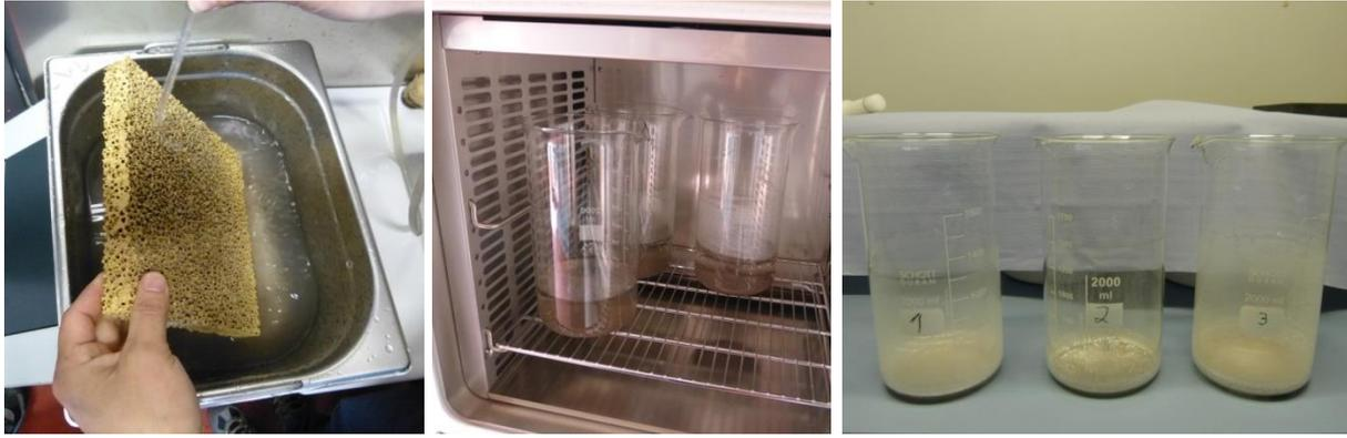
Abbildung 16: Spülen der Schaumkeramikplatten und anschließendes Abdampfen der Spülflüssigkeit
