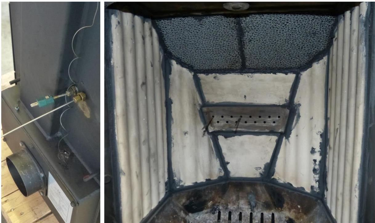
Abbildung 23: Optimierungsmaßnahmen vor dem Langzeitversuch: Nachrüstung einer Temperatur- und Druckmessstelle im Feuerraum und Abdichten der undichten Stellen mit feuerfestem Keramikkleber
