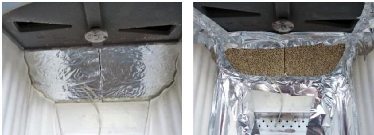
Abbildung 13: Vorversuche zum Strömungsverhalten: Schritt 2: Schaumkeramik abgeklebt (links), Schritt 4: alle undichten Stellen abgeklebt, Klebeband von Schaumkeramik wieder entfernt (rechts)
