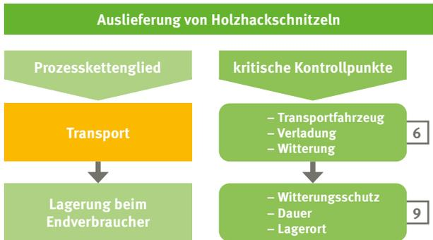
Abbildung 9.4: Prozessbeschreibung zur Auslieferung von Holzhackschnitzeln (angelehnt an DIN EN 15234-4)
