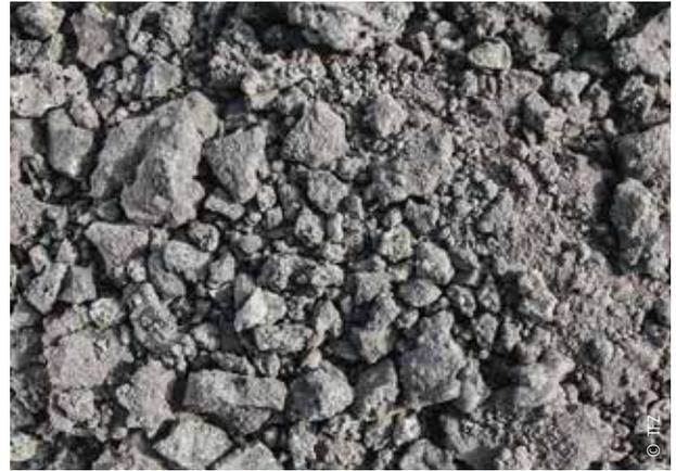
Beispiel für extreme Schlackebildung bei unpassender Brennstoffqualität, angefallen im Aschebehälter einer 1,3 MW Feuerung
