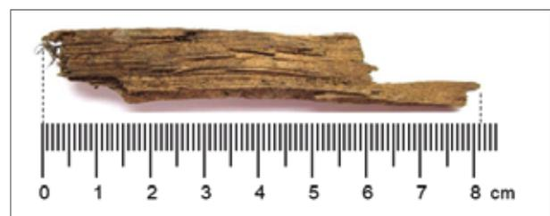
Abbildung 10.7: Beispiel für die Bestimmung der Länge eines Hackschnitzels. Sobald der Querschnitt des Partikels 0,5 cm<sup>2</sup> überschreitet, ist die gesamte Partikellänge zu berücksichtigen. (Länge des Beispiel-Hackschnitzels: 81 mm)
