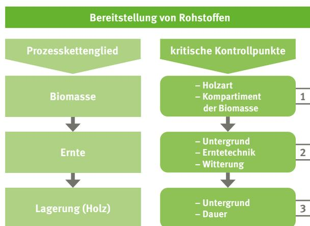
Abbildung 9.2: Prozessbeschreibung zur Bereitstellung von Rohstoffen (angelehnt an DIN EN 15234-4)
