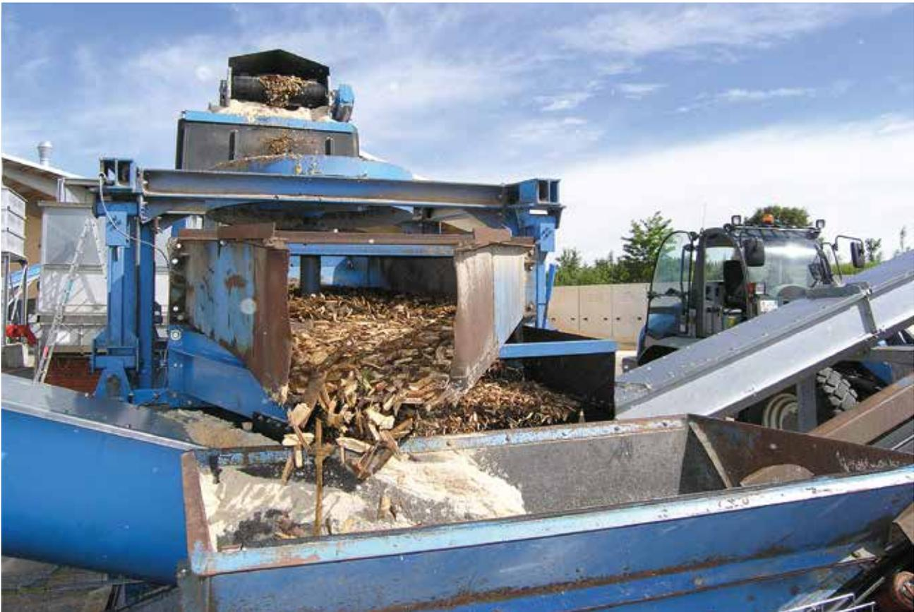
*Aufbereitung von Holzhackschnitzeln mit einem Schwingsieb*
