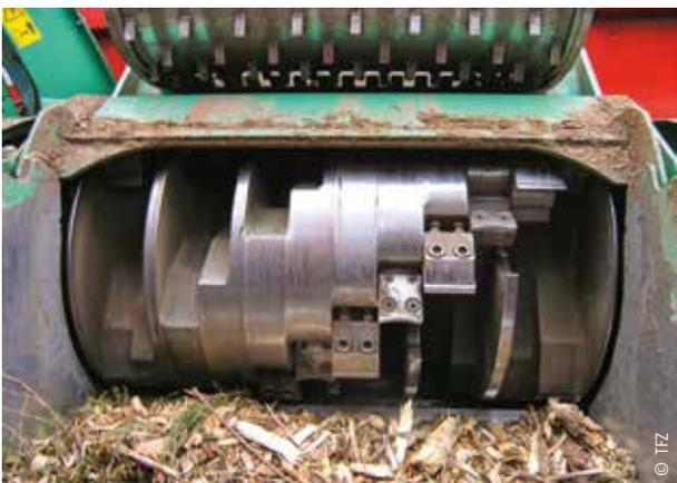
Beispiel für ein Schneidaggregat: Halbdurchlässige Hackertrommel mit versetzten Messern
