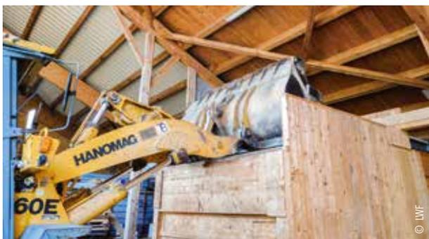
Schubbodentrockner (Eigenbau) (oben) und Befüllung des Trockners mittels Radlader (unten)
