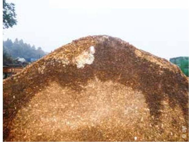
Beispiel für Schichtbildung in einem Holzhackschnitzelhaufwerk
