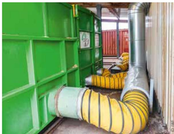
Trocknungscontainer angeschlossen an ein Gebläse
