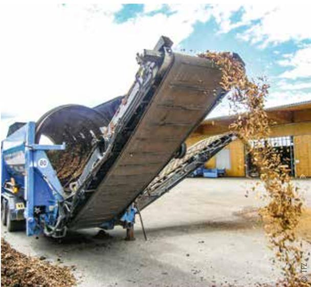
*Siebung von Holz hackschnitzeln mit einem Trommelsieb.*
