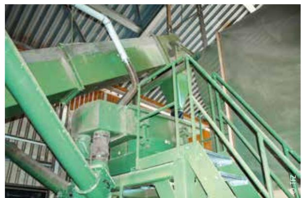
Allgaier Wälzbettrockner WB-T mit Zyklon (oben) und Backers Schwingsieb (unten)
