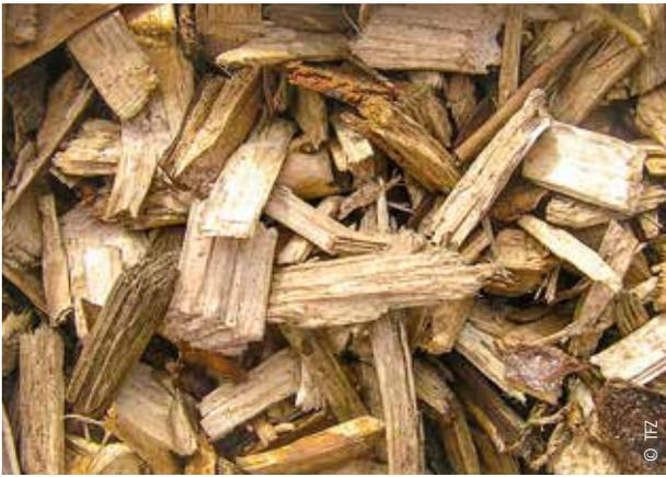
Frische Waldrestholzhackschnitzel vor (oben) und nach (unten) der Aufbereitung aus Fallstudie 6a mittels Schwingsieb und Bandrockner. Größe des Bildausschnittes ca. DIN A5
