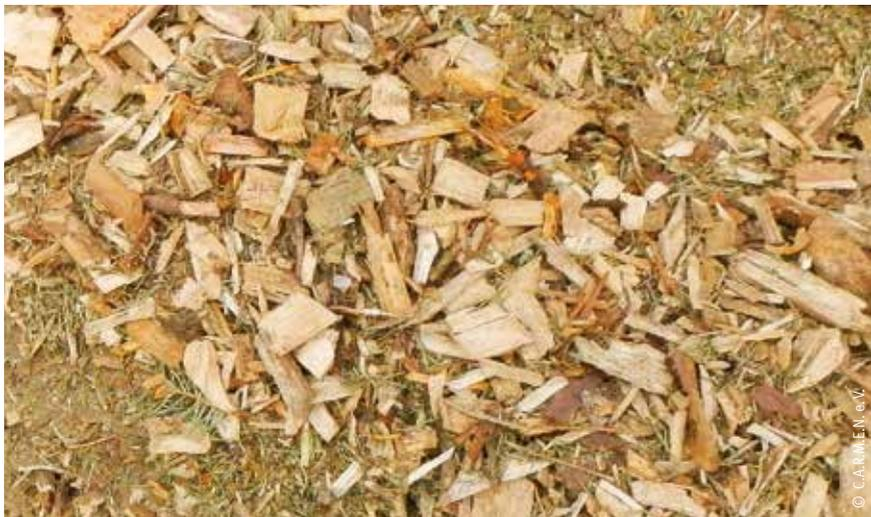
Abb. 13: Hackschnitzel mit hohem Feinanteil, durch Lagerung ungleichmäßig verteilt, für den emissionsarmen Betrieb von Kleinfeuerungen nicht geeignet.
