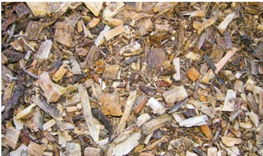
Abb. 14: Hackschnitzel mit hohen Rindenanteilen und Anzeichen von Verrottung und Schimmelbildung, für den emissionsarmen Betrieb von Kleinfeuerungen nicht geeignet.
