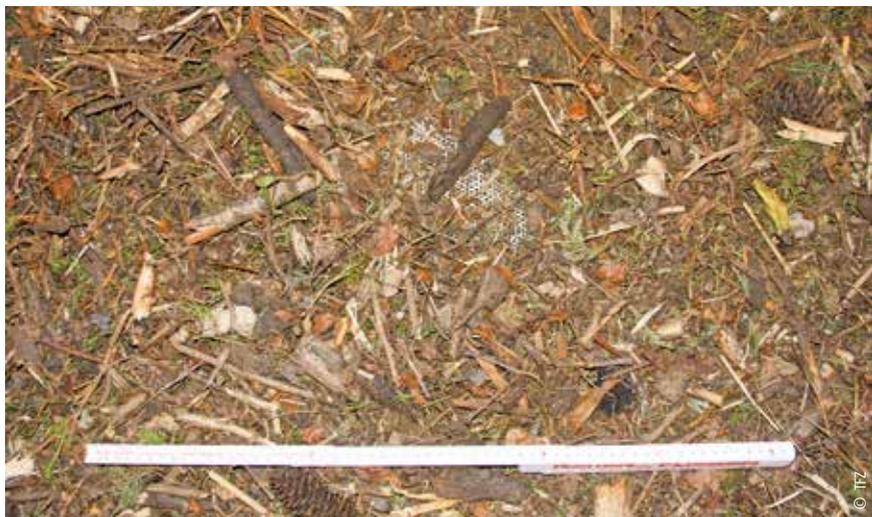
Abb. 12: Hackschnitzel mit Nadeln, Rinde, feinen Ästen und deutlichen Verunreinigungen mit Mineralboden. Aschegehalt > 10 Masse-%, für den emissionsarmen Betrieb von Kleinfeuerungen nicht geeignet.
