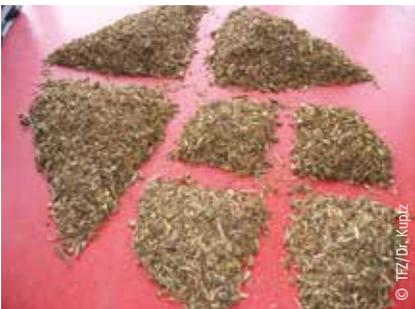
Die Rückstellprobe (ca. 10 l) wird durch mehrfache Vierteilung von der Gesamtprobe abgetrennt.
