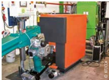
*Hackschnitzelheizung mit Staubfilter im Feldtest*
