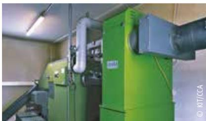
Staubabscheider im Feldversuch
