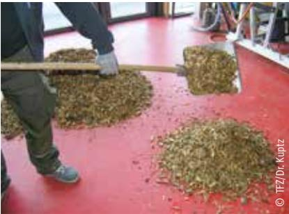
Die Gesamtprobe wird dreimal mithilfe einer Schaufel komplett umgesetzt.
