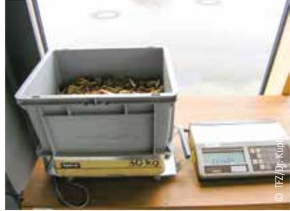
Für eine nachträgliche Bestimmung des Wassergehaltes wird das Nettogewicht der Rückstellprobe direkt im Anschluss an die Probenahme ermittelt.
