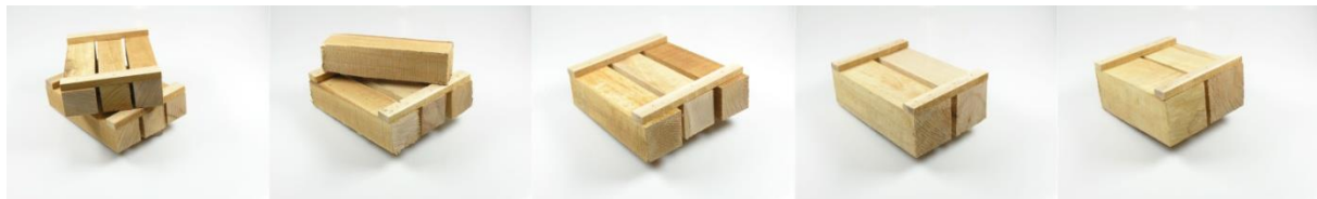
Abbildung 20: Scheitgrößenvariation von 5 x 5 cm bis 9 x 9 cm Kantenlänge mit Buchenholz ohne Rinde bei vergleichbarer Auflegemasse
