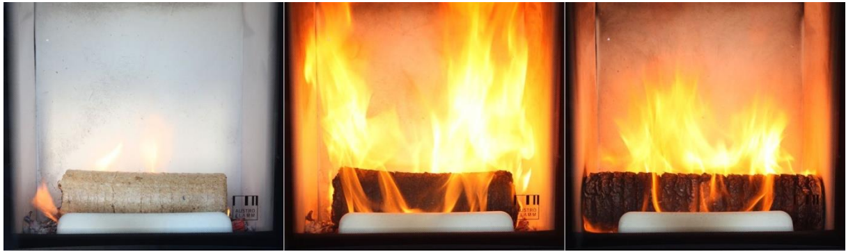
Abbildung 56: Verhalten eines runden Holzbriketts mit Loch während der Verbrennung in einem Kaminofen. Die Länge des Briketts nimmt von links nach rechts während des Abbrandes zu. Daher sind lange Briketts vorzubereiten.
