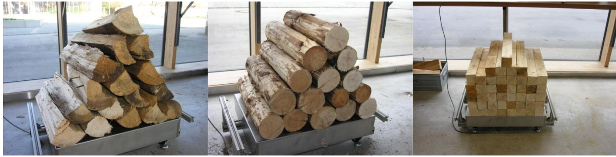
Abbildung 19: Brennstoffaufbereitungsformen für die Versuche am HDG Navora Scheitholz-kessel. von links nach rechts: Scheitholz mit D10 - D12, Rundlinge mit D10 - D12 und Kanthölzer der Abmaße 7 x 7 cm, jeweils Halbmeterscheite
