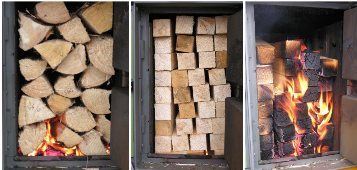
Abbildung 78: Einsatz von Scheit- und Kanthölzern im Scheitholzessel HDG Navora, links: direkt nach dem Befüllen des Füllschachtes mit Scheitholz. Mitte: Befüllen mit Kantholz, rechts: nach der ersten einstündigen Messung brennt der gesamte Holzvorrat, die Verbrennung ist nicht auf den Glutbettbereich beschränkt
