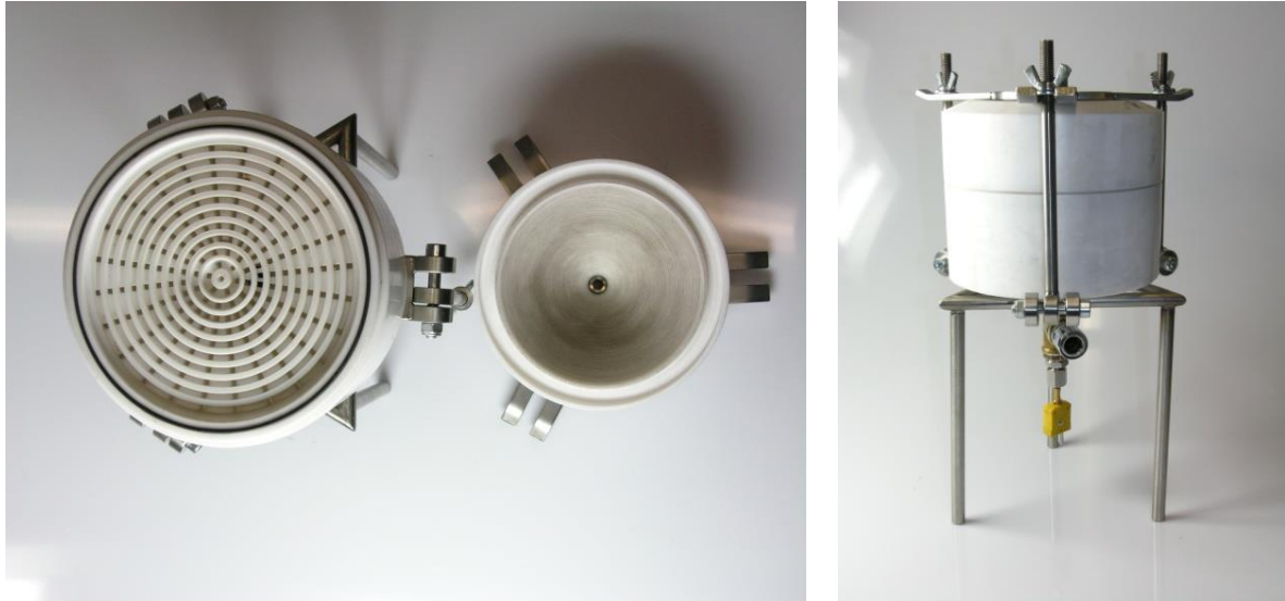
Abbildung 11: Filterhalter für große Planfilter mit 150 mm Durchmesser, Eigenentwicklung des TFZ
