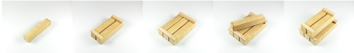
Abbildung 22: Variation der Nachlegemasse mit Buchenholz bei konstanter Kantenlänge von 5 x 5 x 25 cm und Anzahl Kanthölzer
