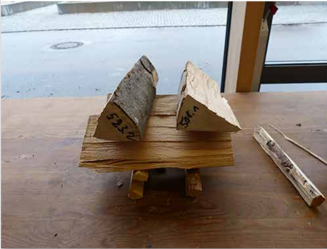
■ Bild 2: Beispiele zweiter untersuchter Anzündvarianten (Zündstapel) (Foto: Robert Mack)
