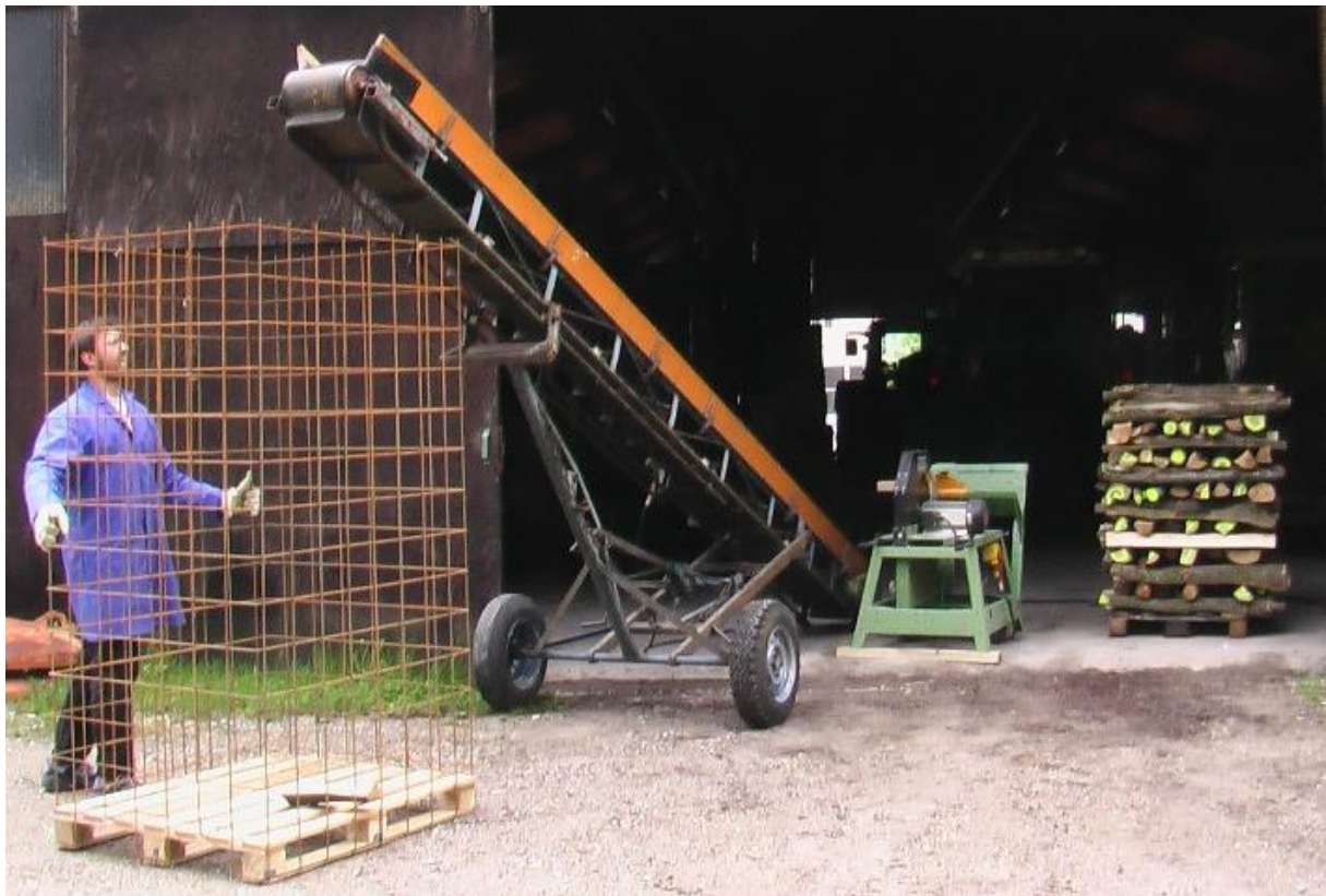
Abbildung 19: Befüllen der Gitterbox für die Schüttvolumenbestimmung
