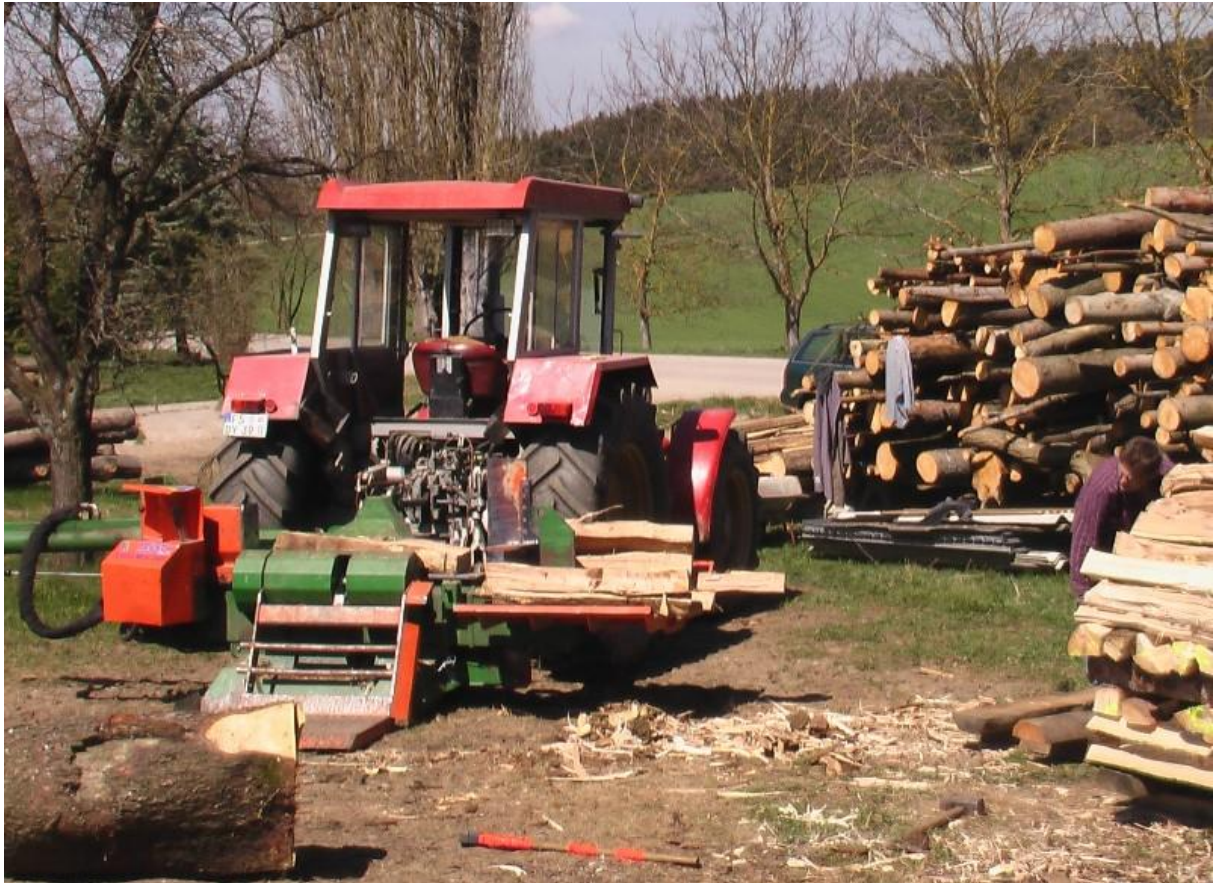
Abbildung 62: Arbeitsplatzbeispiel für Zeitstudie zum Spalten mit großem Waagrechtspalter (hier: Hydromax 24 t, Fa. Posch)
