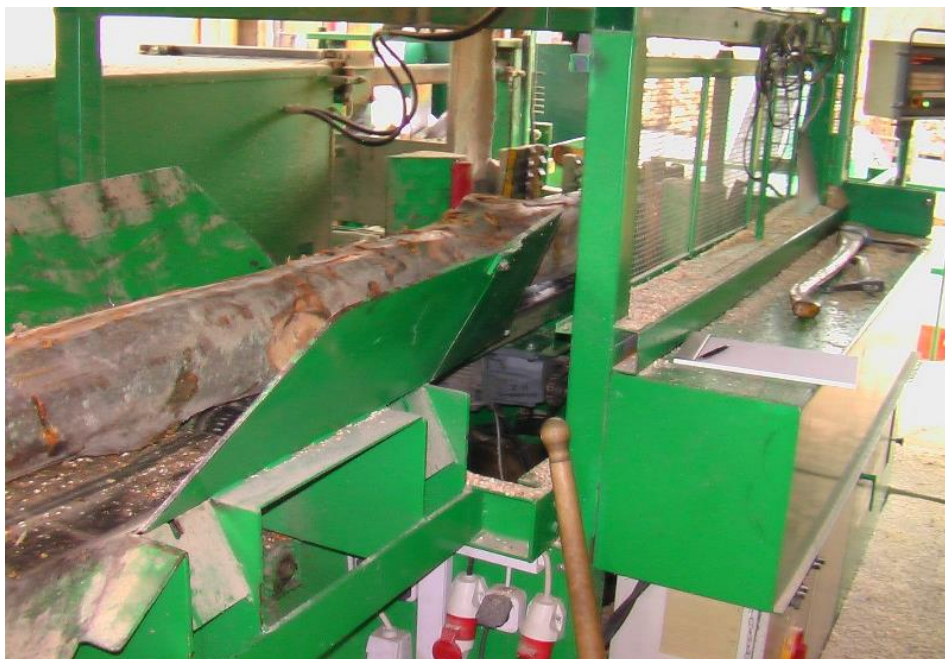
Abbildung 71: Arbeitsplatzbeispiel für Zeitstudie zum Spalten mit der großen kombinierten Säge-Spaltmaschine (GK). Hier: Herkules II, Fa. Kretzer
