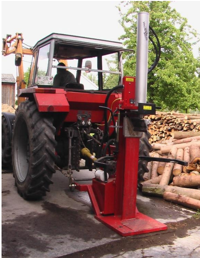
Abbildung 57: Arbeitsplatzbeispiel für Zeitstudie zum Spalten mit großem Senkrechtpalter (hier: Spaltbrummi, Fa. Vogesenblitz)
