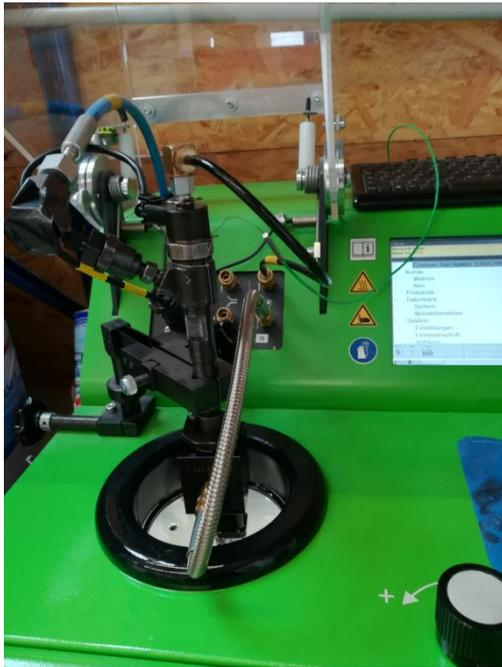
Abbildung 6: Motorunabhängiger Einspritzprüfstand
