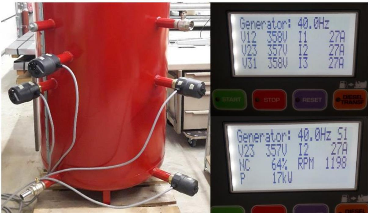
Abbildung 19: Testlauf zur Last- und Drehzahlsteuerung
