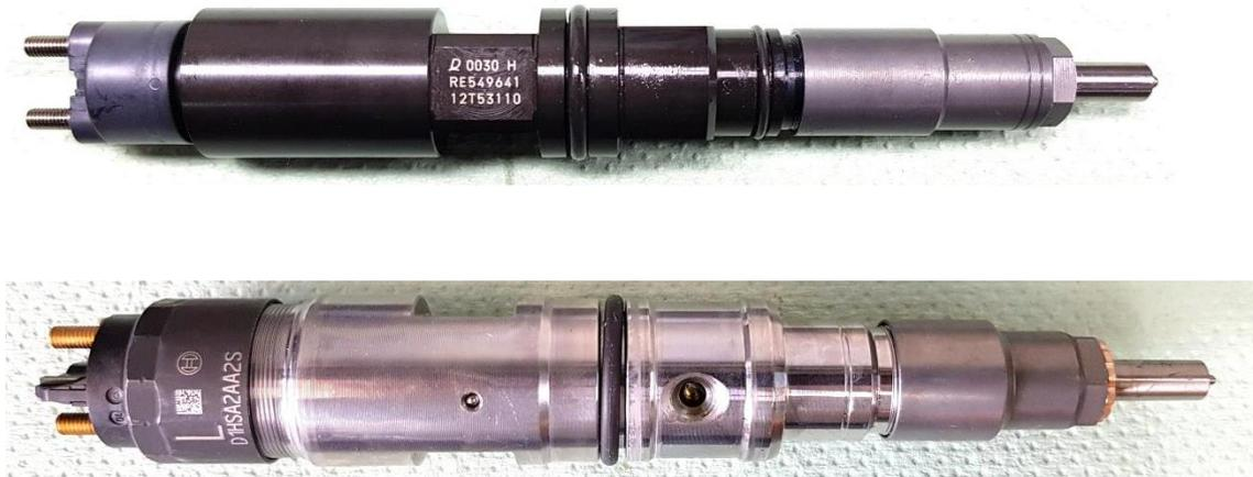
Abbildung 55: Heavy-Duty-injektoren; Denso (oben); Bosch (unten)
