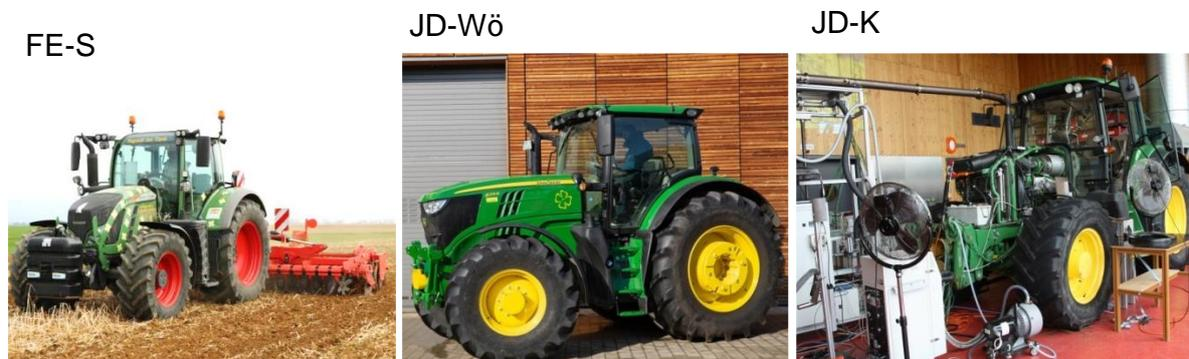
Abbildung 78: Rapsöлтаugliche Traktoren Fendt Vario 724 S4 (FE-S) und John Deere 6215R (JD-Wö) im Praxiseinsatz sowie der Traktor John Deere 6930 Premium (JD-K) am Traktorenprüfstand
