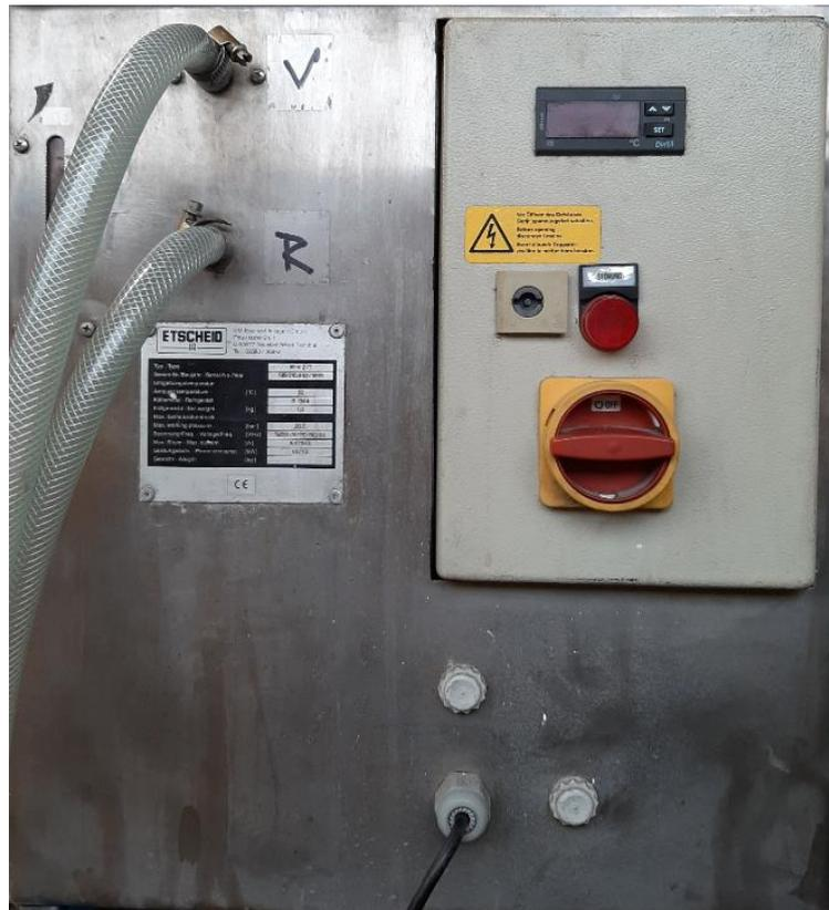
Abbildung 44: Durchlaufkühler zur Kraftstoffkühlung
