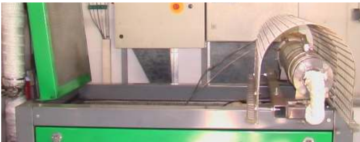
Abbildung 18: Veränderte Abgasführung für Partikelfiltersystem „e“
