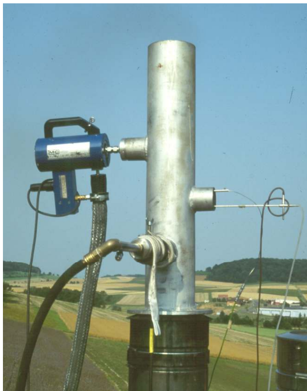
Abbildung 20: Kaminmessaufsatz für die wiederkehrenden Emissionsmessungen an BHKW B und C
