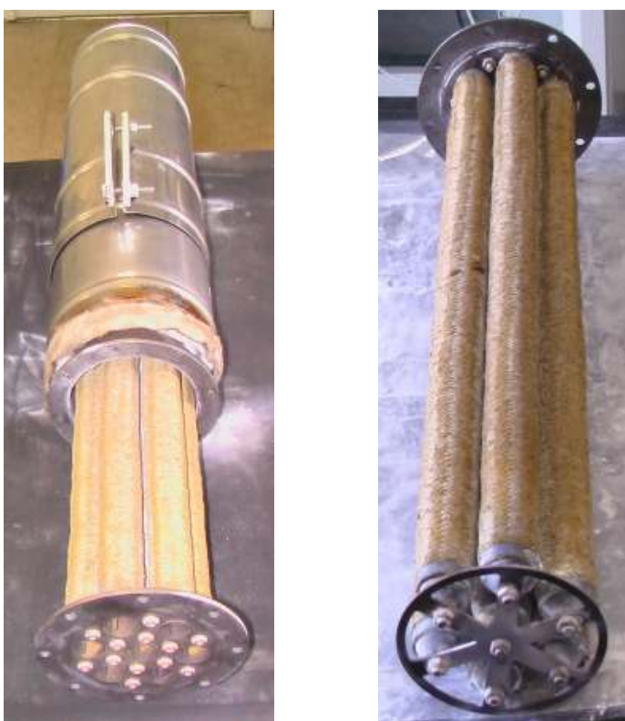
Abbildung 16: Abgaspartikelfiltersystem „e“ mit katalytisch beschichteten Glasfasergeflechtfilterkerzen Bild links: Filterkerzen, teilweise im Gehäuse; Bild rechts: Filterkerzen ohne umgebendes Gehäuse
