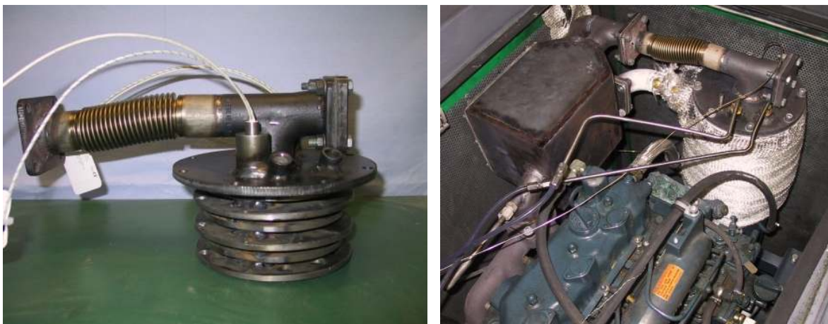
Abbildung 17: Abgasheizung für die Untersuchung mit Dieselpartikelfilter „d2“ und „d3“
