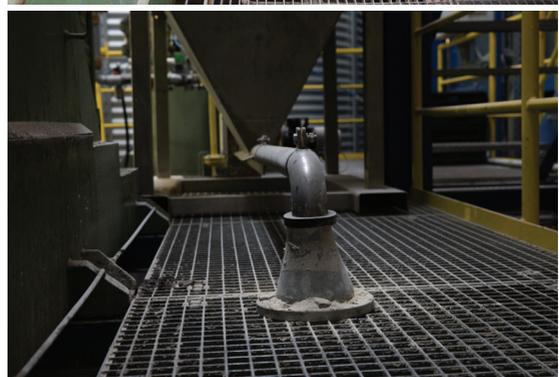
Förder- und Dosiertechnik zur Einbringung eines Zuschlagstoffs in den Truböltank
