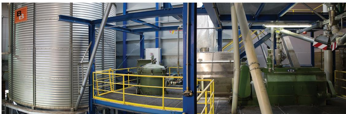
Integration von Förder- und Dosiertechnik zur adsorptiven Reinigung von Rapsölkraftstoff in einer dezentralen Ölmühle
