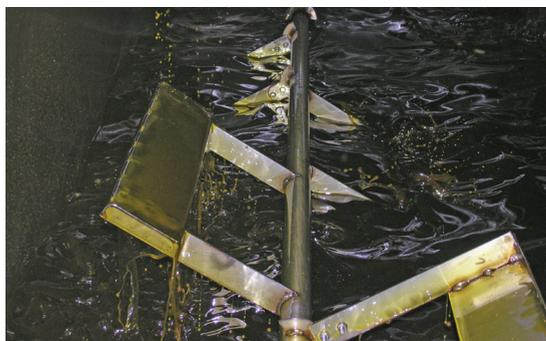
Permanentes Rühren sorgt für gute Durchmischung des Öls mit den Zuschlagstoffen
