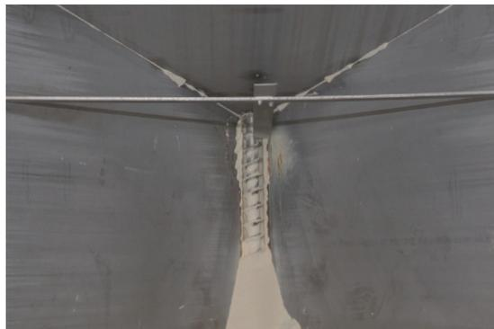
Blick in einen Vorratsbehälter mit Förderschnecke für pulverförmige Stoffe, wie z. B. Bleicherde
