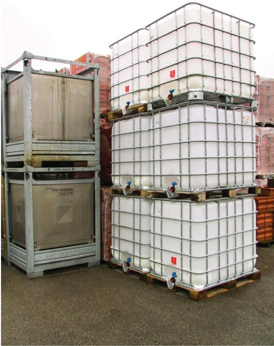
Lagerbehälter aus Edelstahl und Kunststoff (IBC – Intermediate Bulk Container) mit einem Volumen von ca. 1.000 Litern
