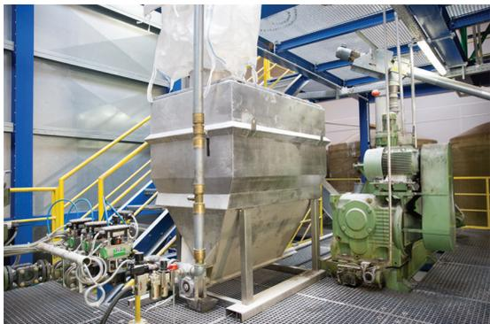
Förder- und Dosiertechnik für pulverförmige Zuschlagstoffe in einer dezentralen Ölmühle
