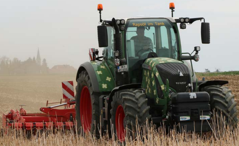
Der Rapsöltraktor Fendt Vario 724 S4 des TFZ arbeitet zuverlässig im Praxiseinsatz
