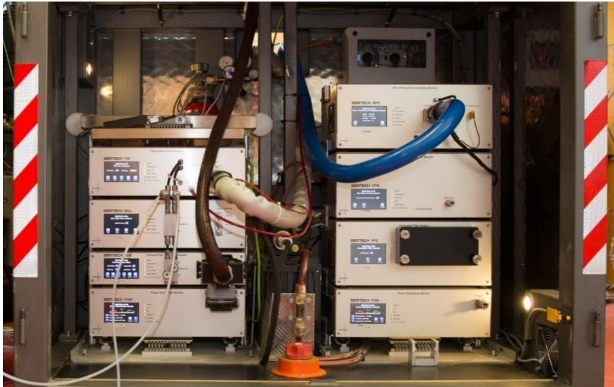
Abbildung 7: Analysatoren des portablen Emissionsmesssystems (PEMS) Semtech Ecostar in der Schutzbox
