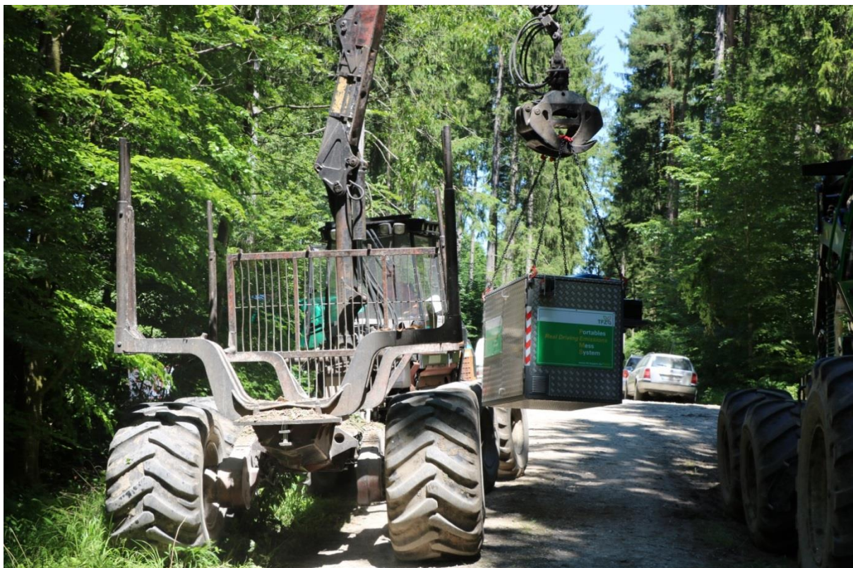
Abbildung 40: PEMS-Box am Kran des Forwarders
