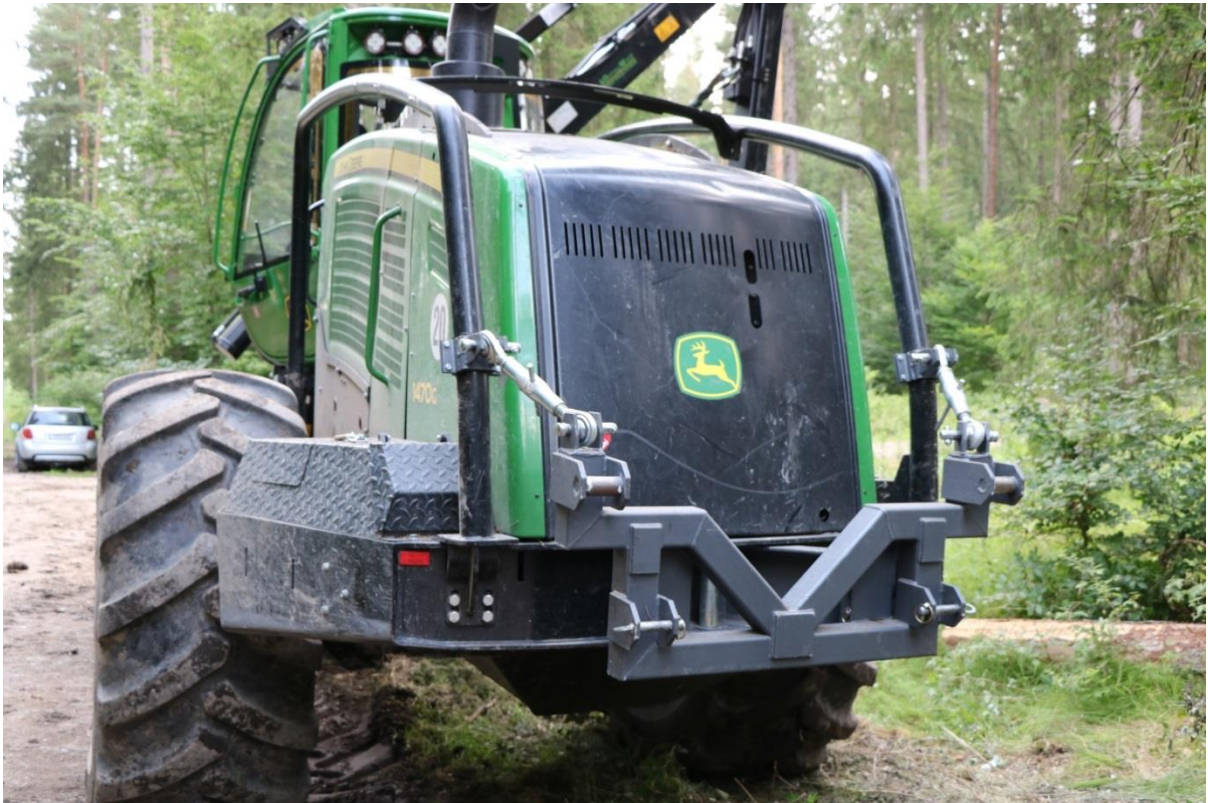
Abbildung 39: Adapterrahmen zur Montage der PEMS-Box am Heck des Harvesters
