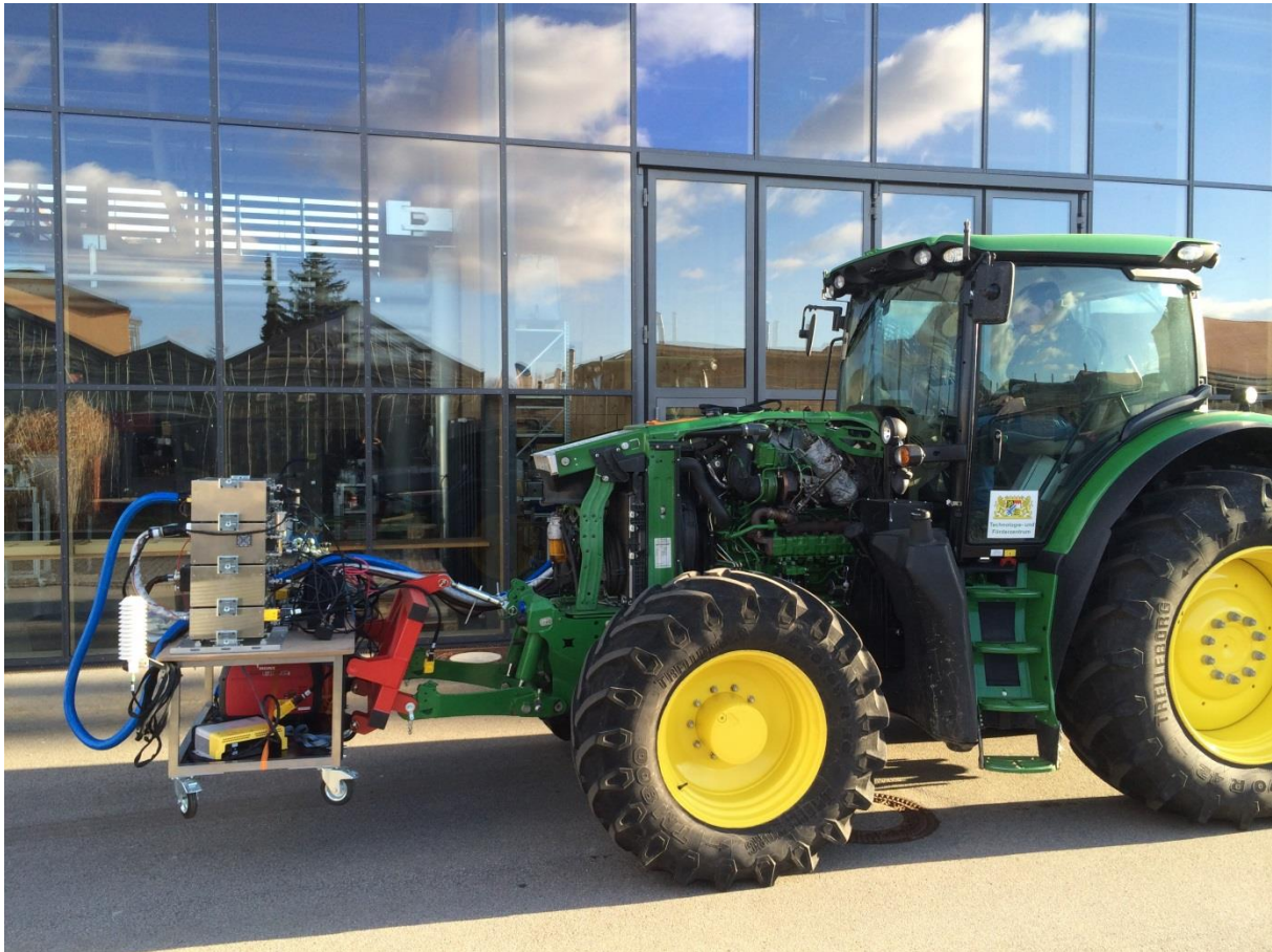
Abbildung 13: Erstinbetriebnahme des PEMS
