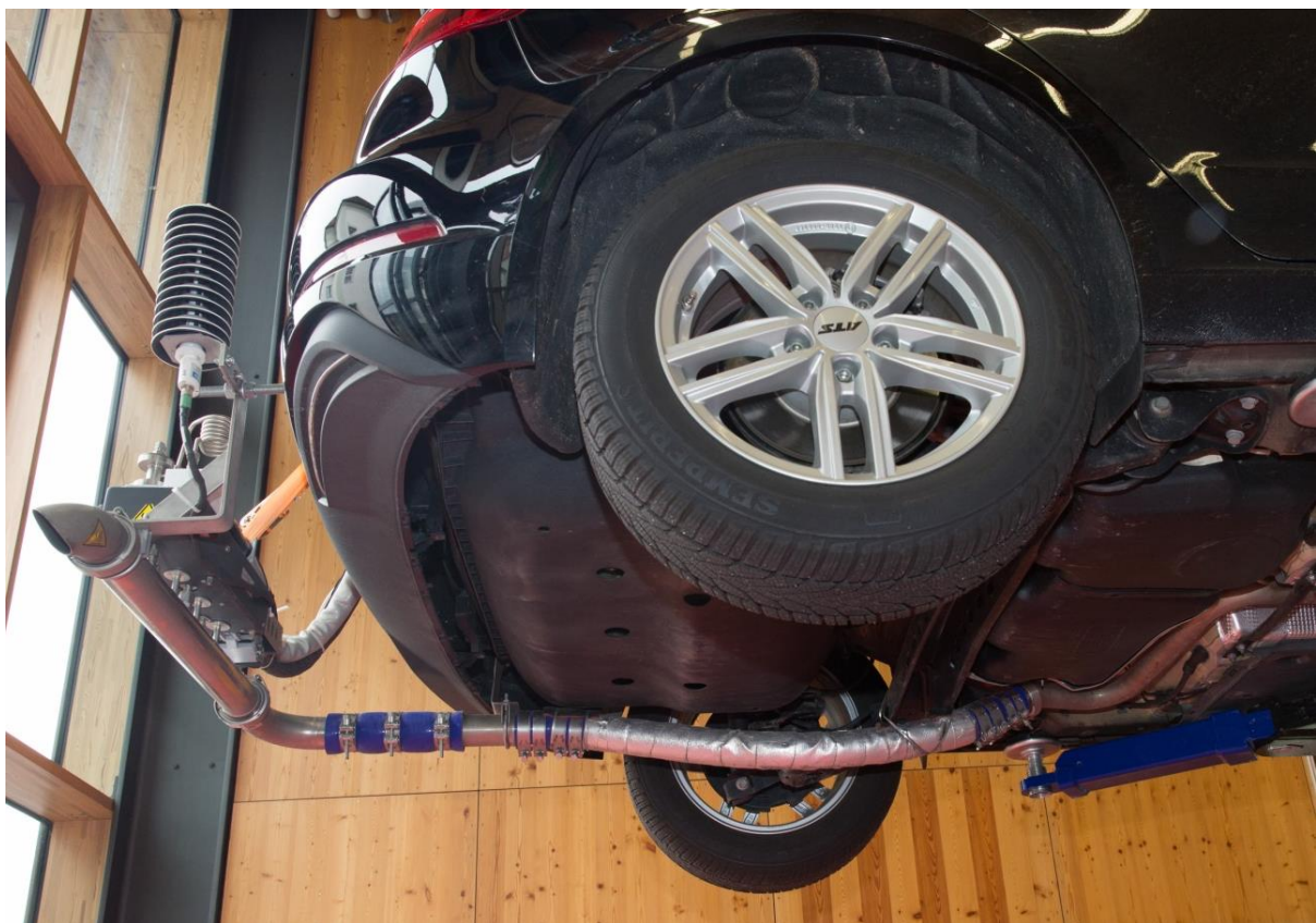
Abbildung 49: Installation der Abgasleitung bis zum Flow Tube am Audi A3 g-tron
