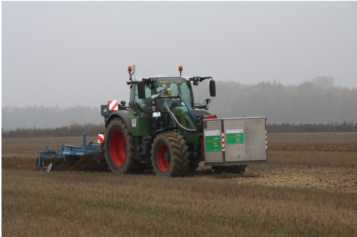
Abbildung 19: PEMS-Messungen auf dem Gutsbetrieb Mainkofen beim Grubbern im Oktober 2015
