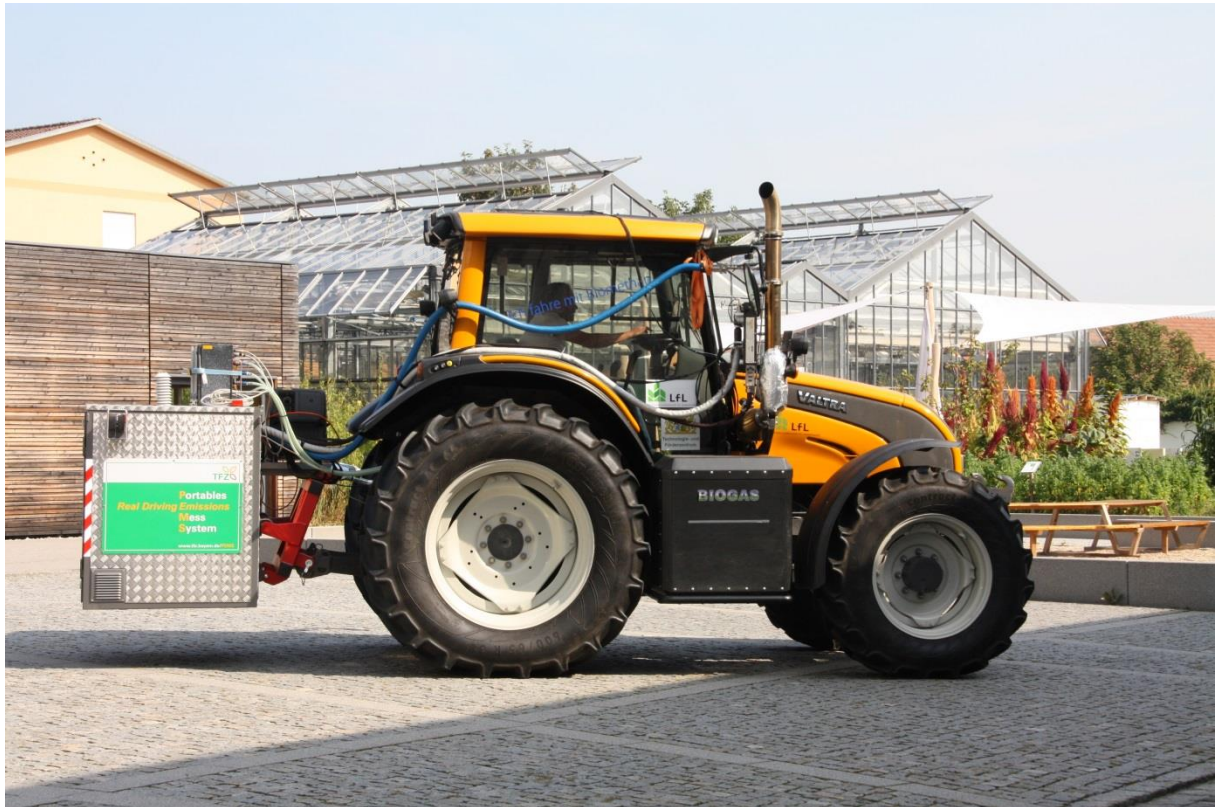
Abbildung 31: Valtra N101 Hi Tech Dual-Fuel mit PEMS
