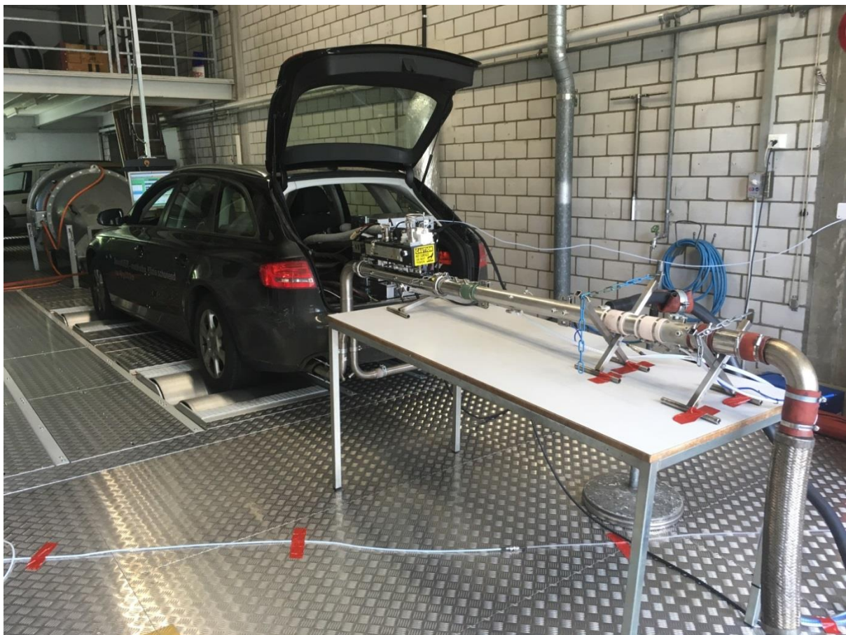
Abbildung 45: Audi Avant A4 2.0 TFSI flexible fuel auf dem Rollenprüfstand der Abgasprüfstelle der FH Bern mit angeschlossener Emissionsmesstechnik
