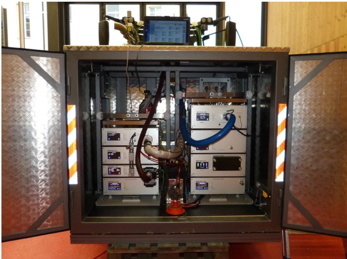
Abbildung 3: Aufbau des PEMS in der speziell entwickelten mobilen Schutzbox vor dem Update
