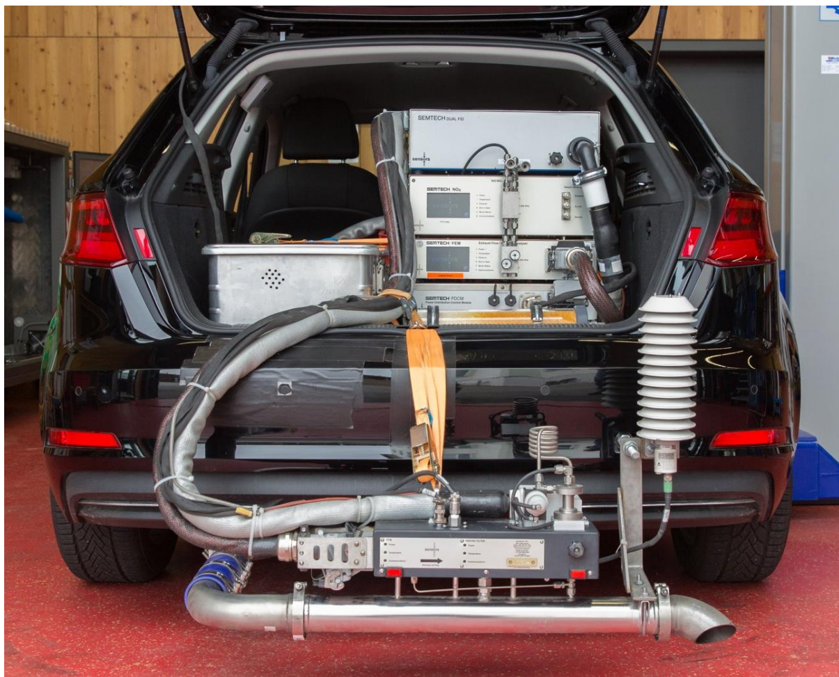
Abbildung 50: Installiertes PEMS am Heck und im Kofferraum des Audi A3 g-tron
