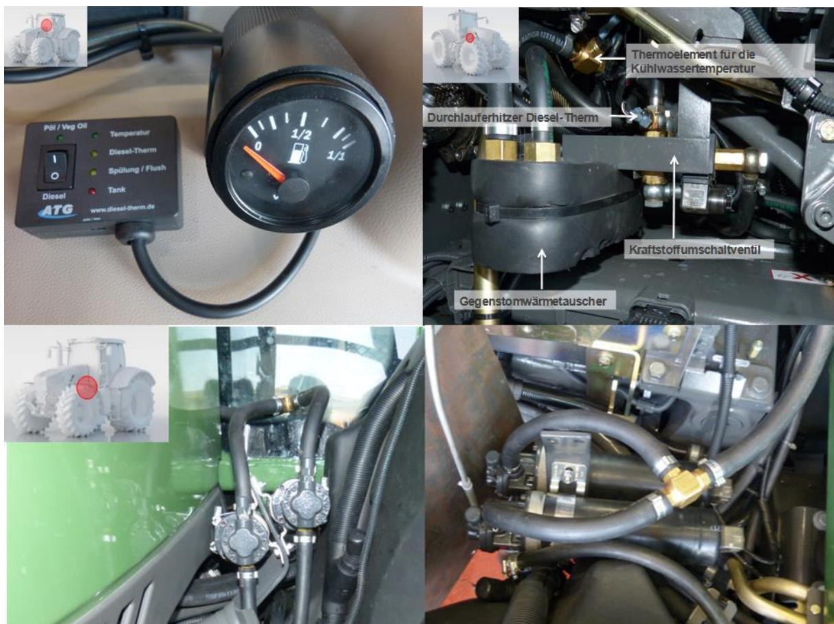
Abbildung 7: Nachgerüsteter Kraftstoffumschalter (links oben) und Füllanzeige für den Dieseltank, zusätzliche Zahnradpumpen für das Pflanzenölkraftstoffsystem (links und rechts unten) sowie Umschalteinheit inkl. Gegenstromwärmetauscher (rechts oben)
