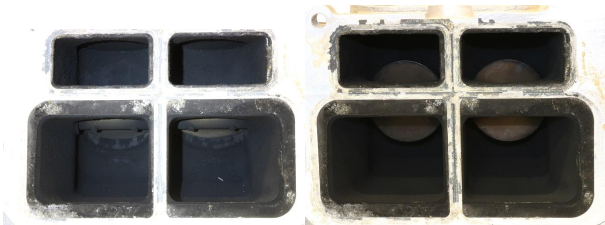
Abbildung 99: AGR-Ventil (links geschlossen und rechts geöffnet) des Traktors Fendt Vario 724 S4 (FE-S)
