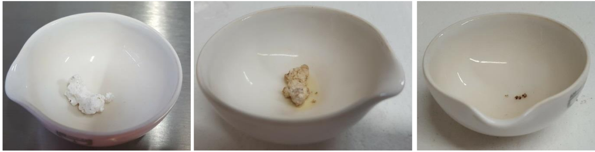
Abbildung 95: Unbehandelte Harnstoffablagerung (links) und Harnstoffablagerung nach der Behandlung im Muffelofen für 2 h bei 400 °C (mittig) und für 2 h bei 500 °C (rechts)
