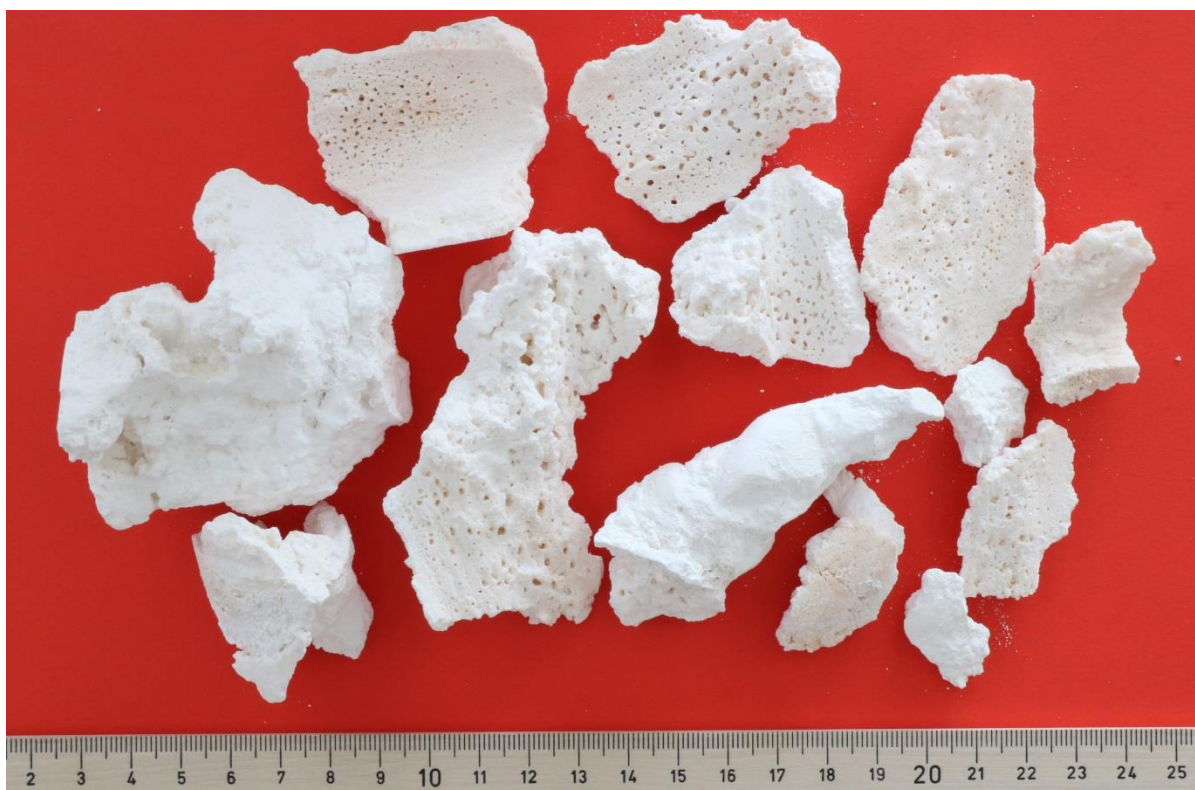
Abbildung 94: Harnstoffablagerungen aus der Mischdüse nach der Dosiereinheit bei 1.010 Bh des Traktors FE-S
