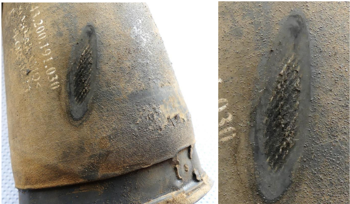
Abbildung 39: Schaden am Ladeluftschlauch des Traktors FE-S (links, vergrößert)
