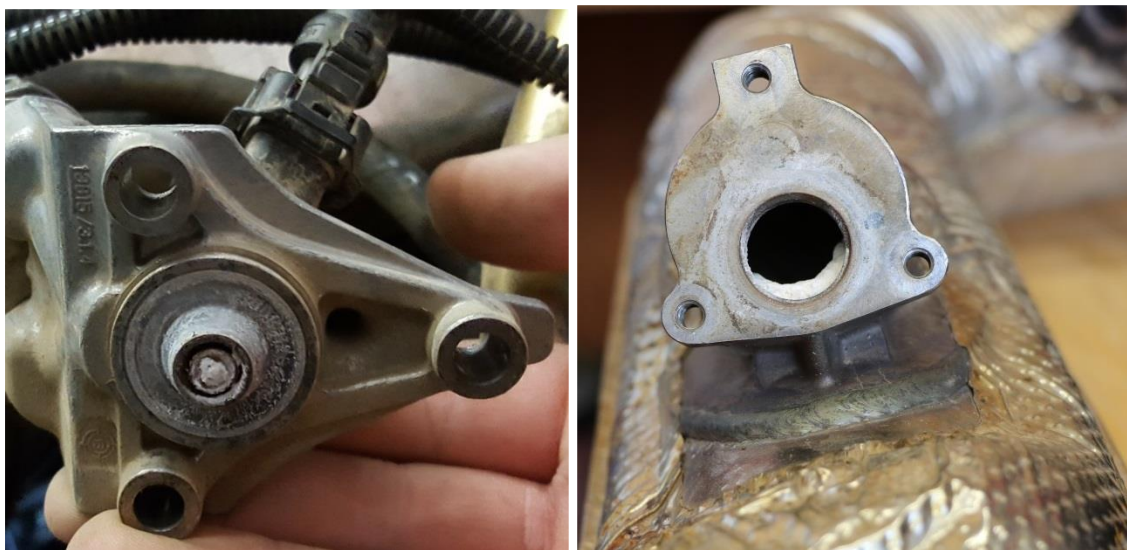
Abbildung 92: Injektor (links) und Injektoraufnahme (rechts) für die Dosierung der Harnstofflösung am Traktor FE-S
