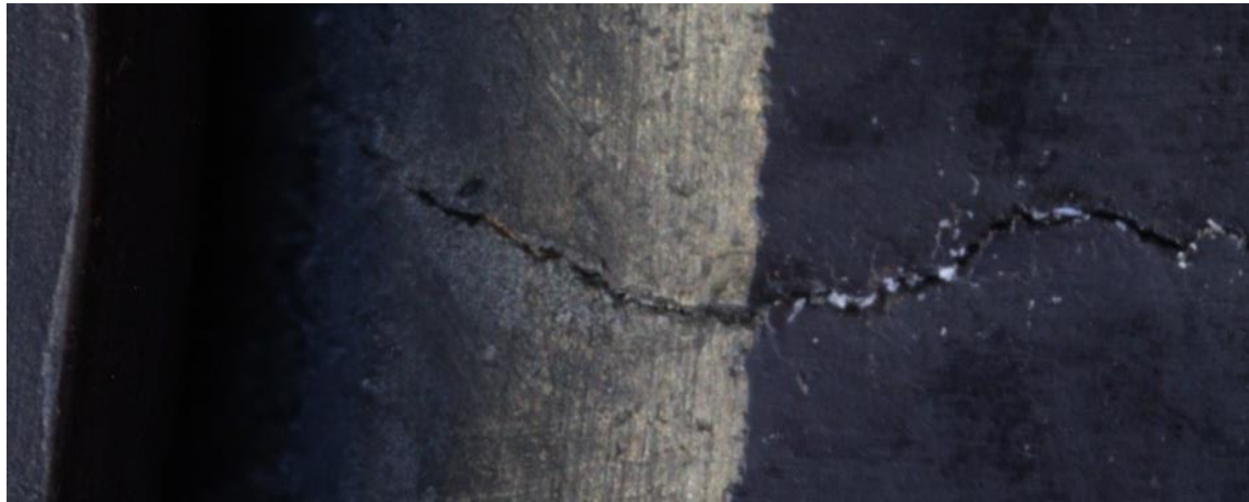
Abbildung 88: Ventilsteigriss des Zylinders 2 (links) des Traktors FE-K bei ca. 7.050 Bh
