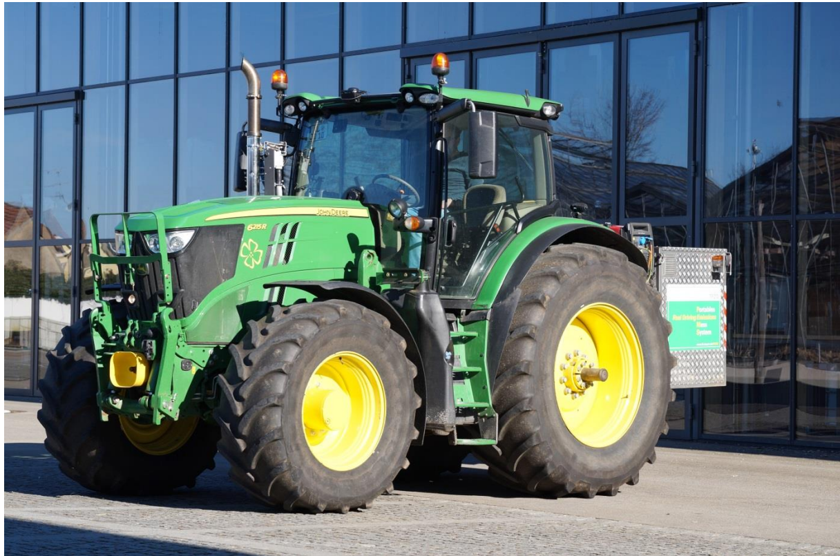
Abbildung 12: John Deere 6215R (JD-S) mit einem portablen Emissionsmesssystem (PEMS) im Heckanbau
