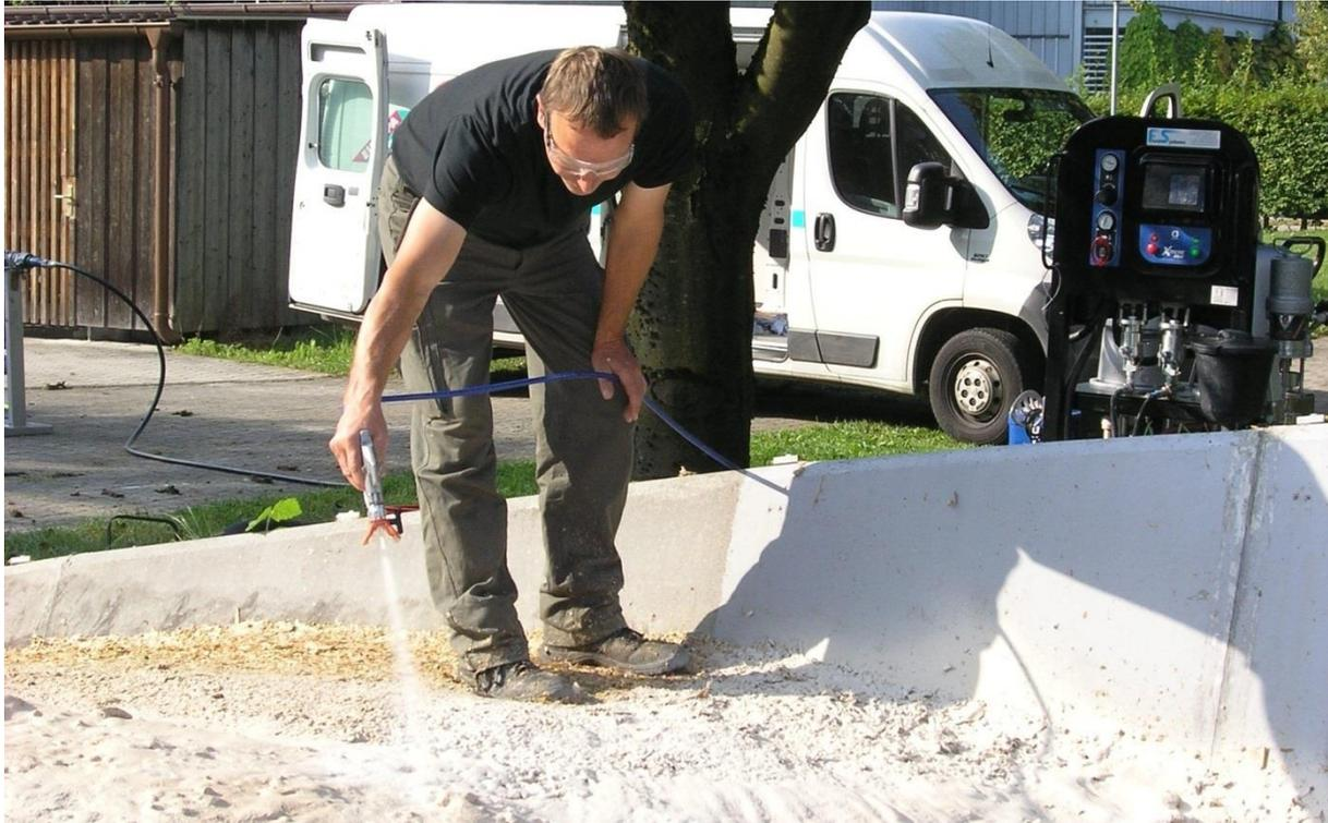
Abbildung 5: Applikation der Silageabdeckung mit dem Zweikomponenten-Lackiergerät Xtreme™ Mix
