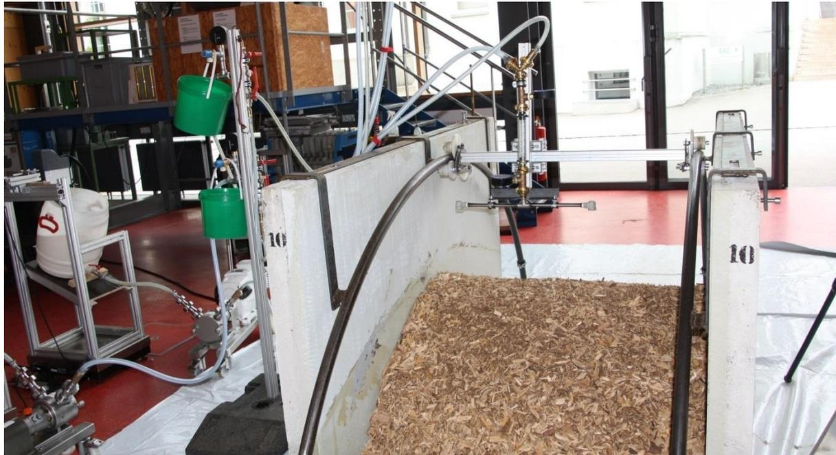
Abbildung 69: Prototyp 3: Spritzkopf des Applikationsgeräts mit zwei Hohlkegeldüsen, befestigt auf der Führungsschiene über einem Miniatursilos
