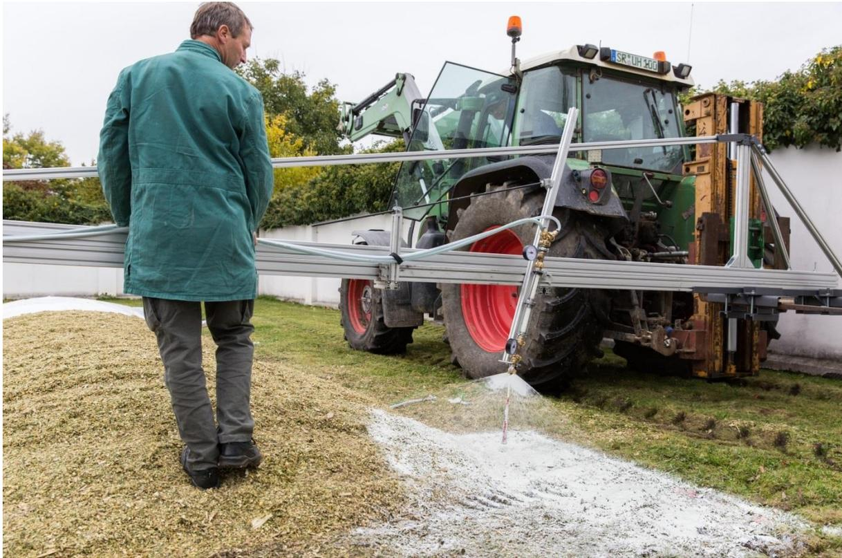
*Abbildung 98: Silierversuche mit Freigärhaufen – Versuchsreihe 3 – Aufspritzen der Rezepturvariante W20 mit Prototyp 3 des Applikationsgeräts, in der Höhe und Neigung verstellbarer Spritzbalken im Heckaufbau eines Traktors*
