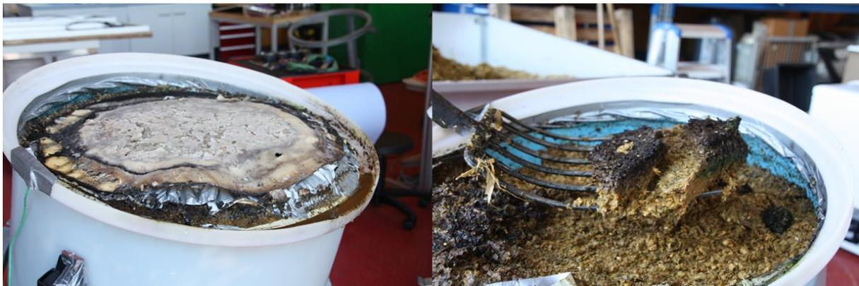
Abbildung 77: Silofass Nr. 4, abgedeckt mit Glycerinvariante A.351 – links: Silofass vor dem Öffnen, rechts: Entnahme der oberen Silageschicht
