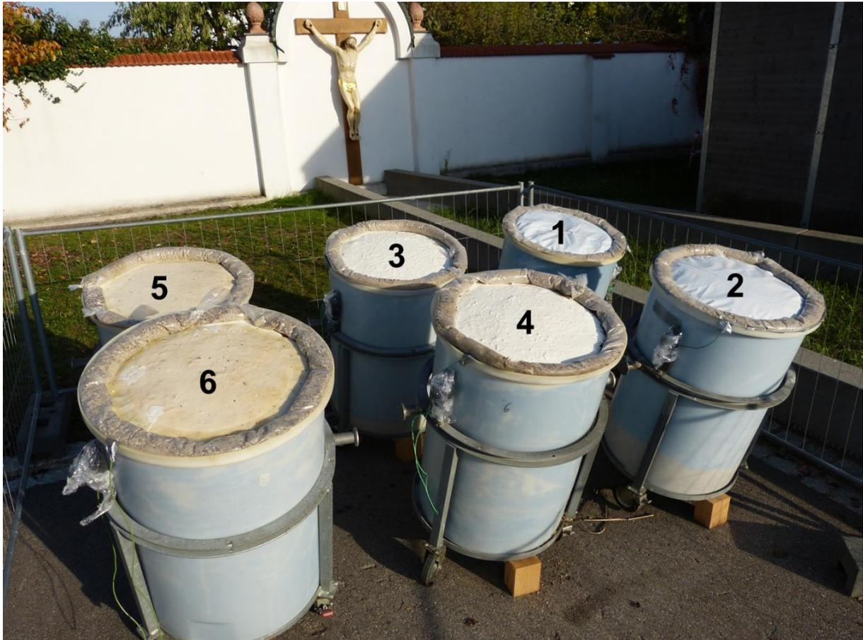
Abbildung 17: Silofässer mit integrierter Temperaturmessung (Fass 1 und 2: Referenz, Fass 3 und 4: Variante A.351 und Fass 5 und 6: Variante 364)
