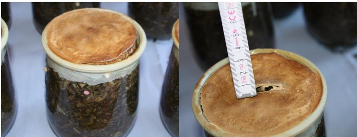
Abbildung 83: Gärglasversuche – Rezepturvariante auf Glycerinbasis (P08) mit sichtbarem Materialschwund und Randablösung
