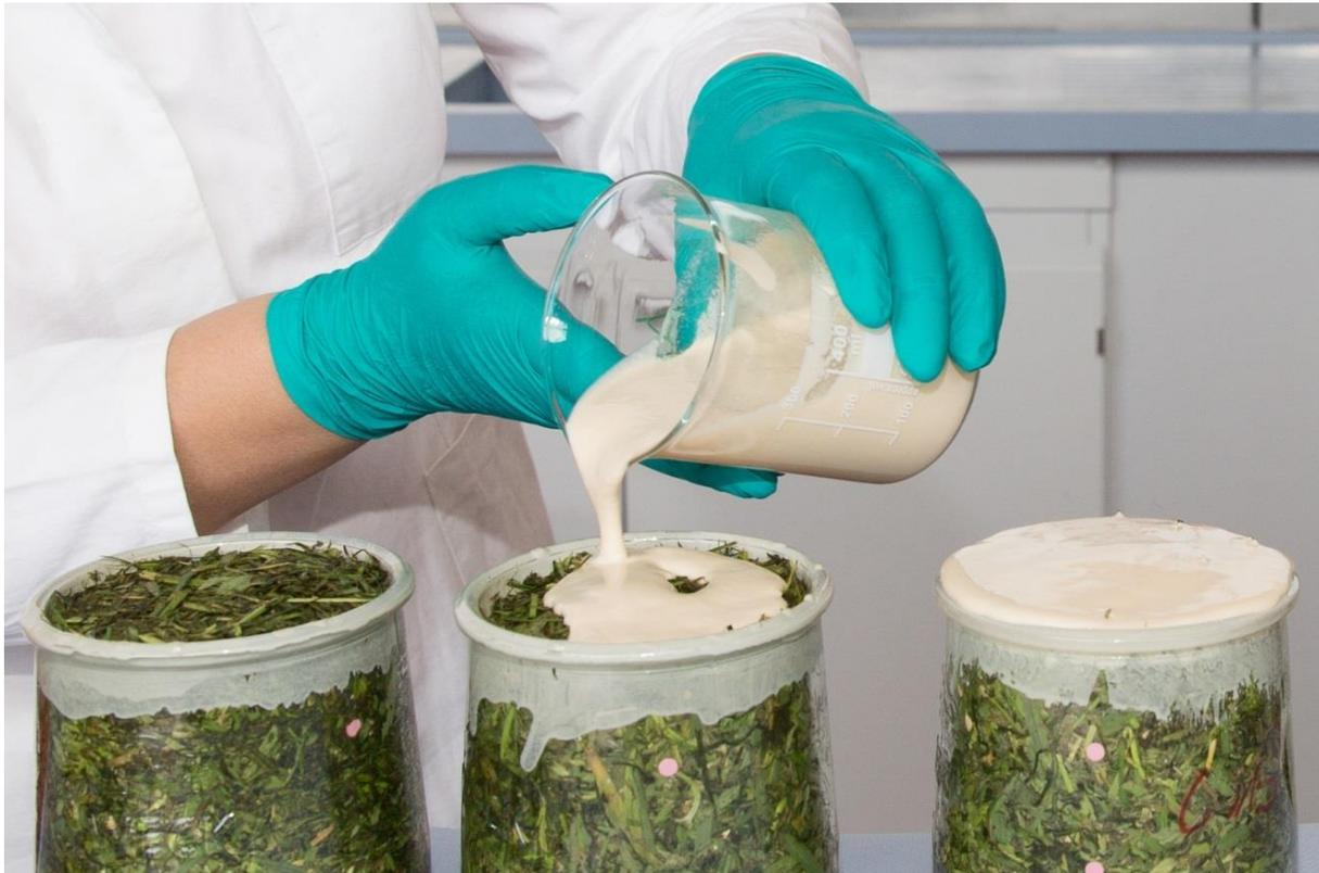
*Abbildung 19: Aufgießen von Abdeckmasse auf das Substrat in mit Silolack „Silodon“ vorbehandelten und mit Sauerstoffspots bestückten Gärgläsern*
