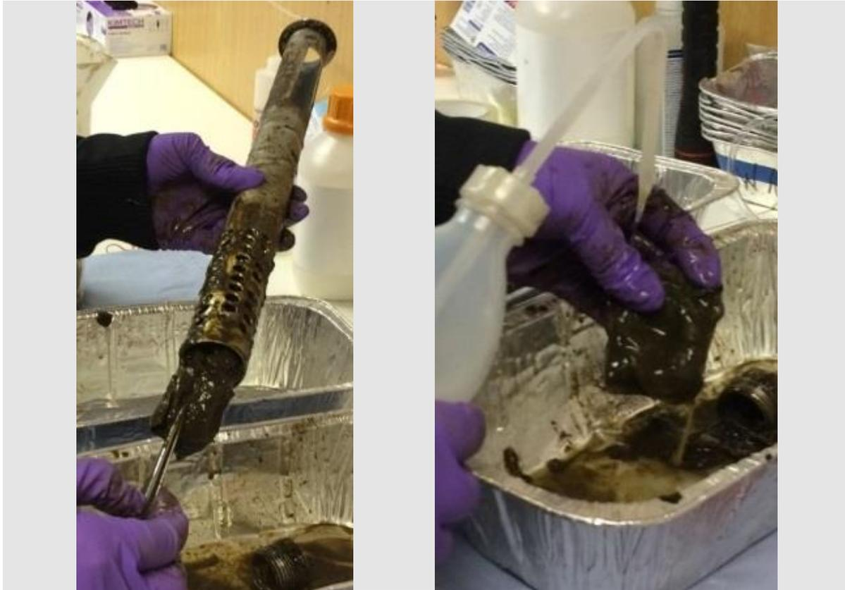
*Abbildung 35: Probenentnahme nach 100 Tagen Exposition (links), Waschen der Probensäckchen mit destilliertem Wasser (rechts)*
