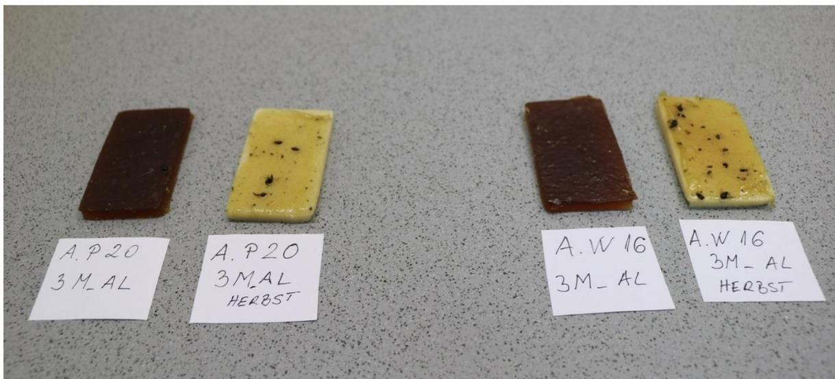
Abbildung 57: Prüfkörper zweier unterschiedlicher Rezepturen (P20 und W16) nach jeweils dreimonatiger Bewitterung im Freien – Zeitraum der Lagerung links: Juni bis August, rechts: September bis November
