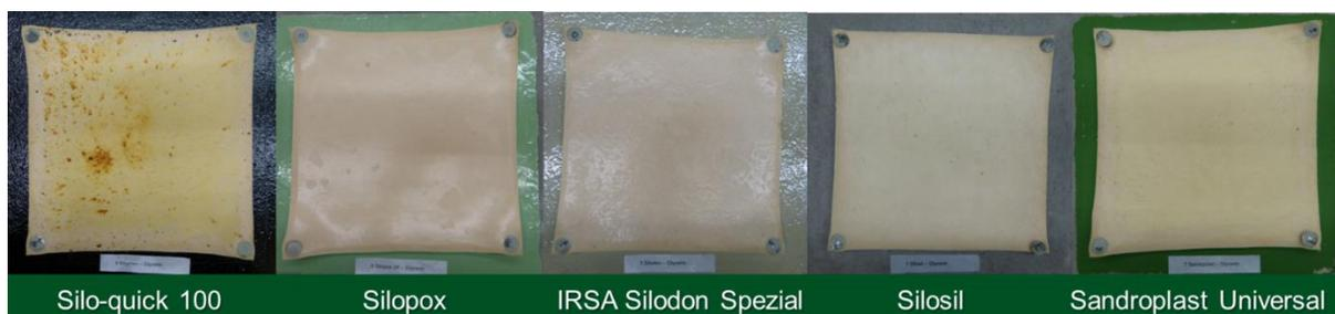
Abbildung 50: Materialunterseite von Prüfkörpern der Rezeptur A.351 nach fünf Monaten Kontakt mit verschiedenen Siloanstrichen
