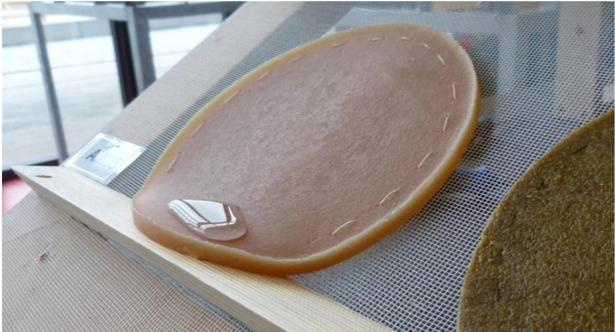
*Abbildung 13: Prüfkörper zur Prüfung der Witterungsbeständigkeit mit Möglichkeit zur Simulation von Staunässe im unteren Drittel des Prüfkörpers*
