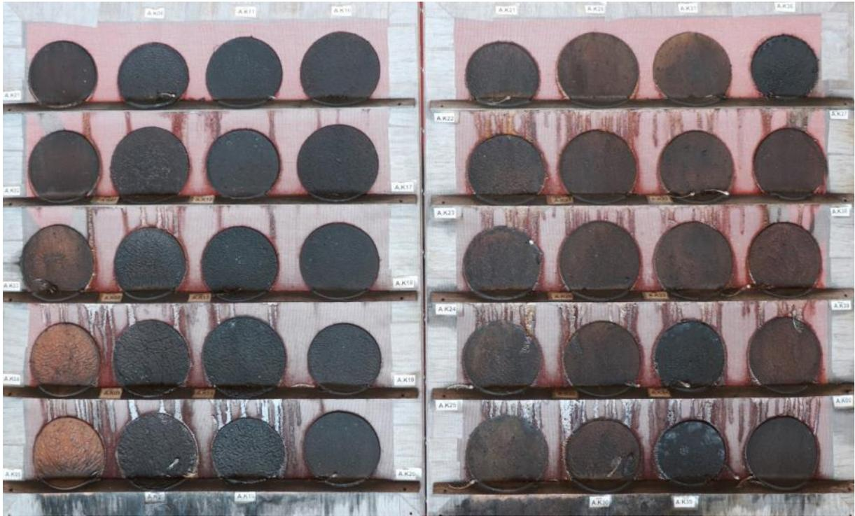
Abbildung 54: Prüfkörper nach 14 Monaten Lagerung im Freien
