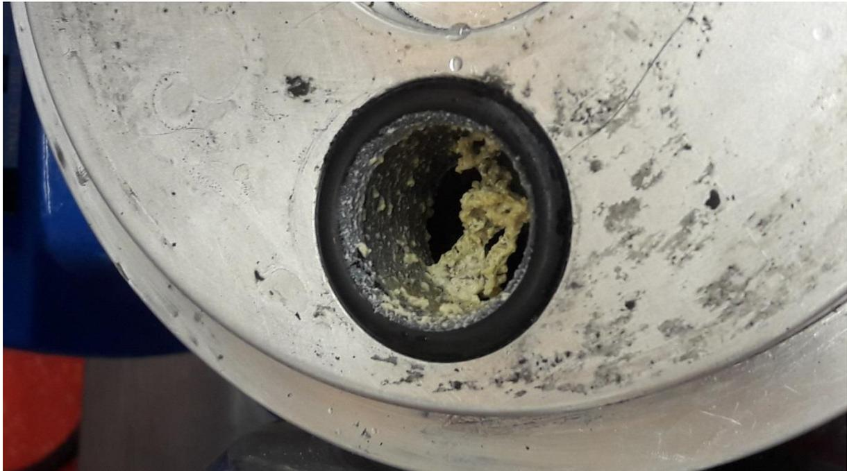
*Abbildung 66: Prototyp 2: Latexkoagulat im Pumpenausgang nach Förderung der Latexkomponente*
