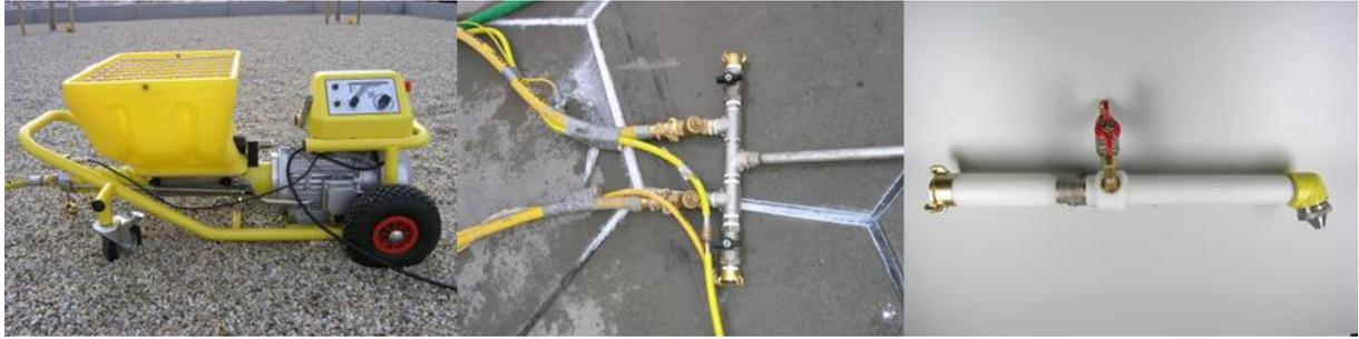
Abbildung 6: Applikationsgerät, bestehend aus zwei „Strobot 406 S“-Pumpen (links), Zusammenleitung der zwei Komponenten (Mitte) und Feinputzspritzgerät mit Statikmischereinsatz (rechts)
