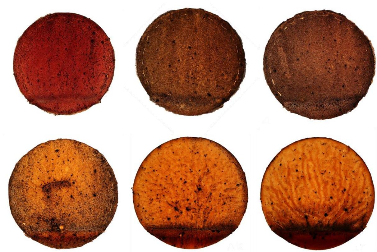
Abbildung 55: Prüfkörper mit zunehmendem Natriumbenzoatgehalt von K00 (0 %) bis K05 (2,5 %) – Reihe oben von links nach rechts: K00, K01, K02 – Reihe unten von links nach rechts: K03, K04, K05 nach 14 Monaten Lagerdauer
