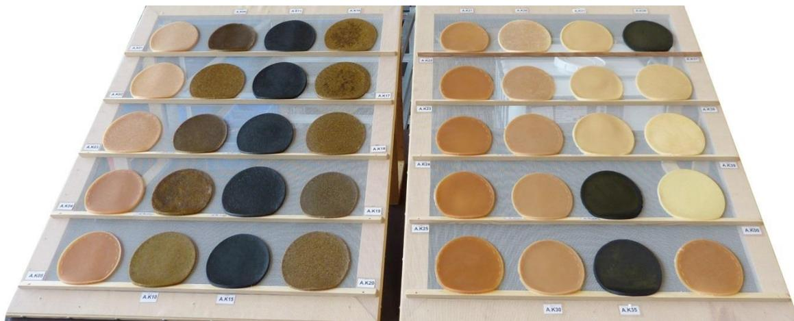
Abbildung 51: Prüfkörper vor Beginn der Lagerung im Freien
