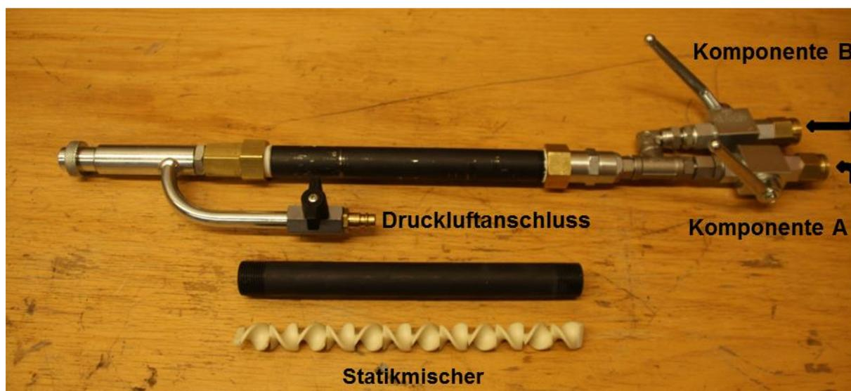
Abbildung 64: Prototyp 2: Sprühkopf mit Statikmischer, Druckluftzerstäubung und Zwei-Komponenten-Eingang
