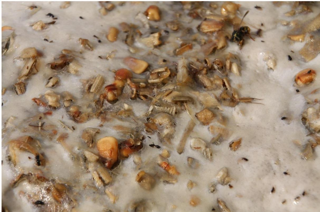
Abbildung 90: *Silierversuche mit Miniatursilos – Versuchsreihe 1 – erste Risse in der Abdeckung A.109 nach sechs Wochen an heraustretendem Pflanzenmaterial*
