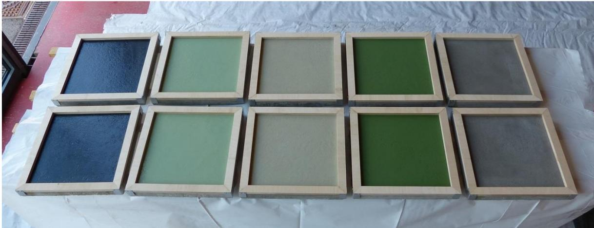
Abbildung 12: Betonplatten mit verschiedenen Silanstrichen und aufgesetzten Rahmen zum Gießen des Abdeckmaterials
