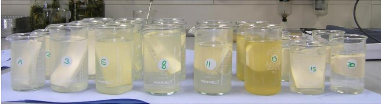
Abbildung 11: Lagerung von Prüfkörpern verschiedener Rezepturen in Wasser
