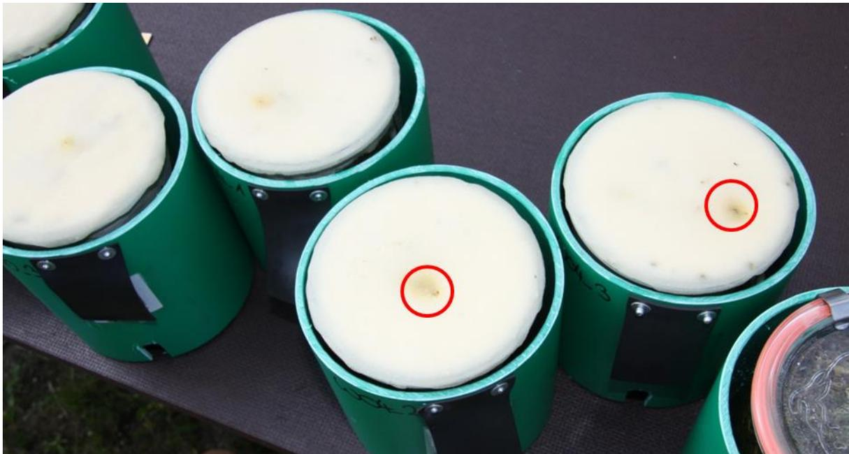
Abbildung 80: Gärglasversuche – Luftkanäle im aufgetragenen Material
