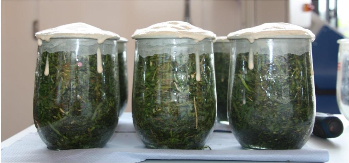
*Abbildung 81: Gärglasversuche – Gärgashauben der Variante P13 ca. vier Stunden nach dem Ausgießen des Materials*
