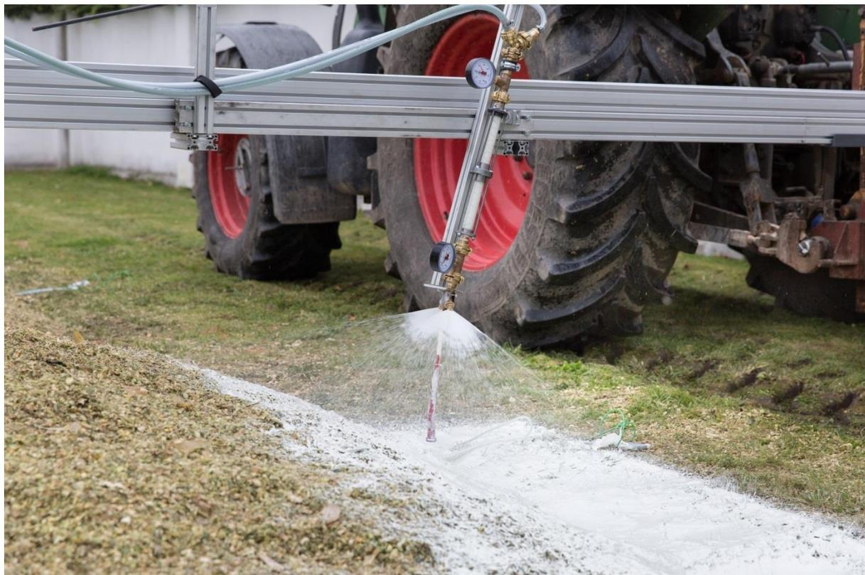
Abbildung 70: Applikationssystem zum Spritzen der Silageabdeckung auf einen Freigärhaufen – höhenverstellbares und in der Neigung anpassbares System mit Doppeldüse im Heckaufbau eines Traktors
