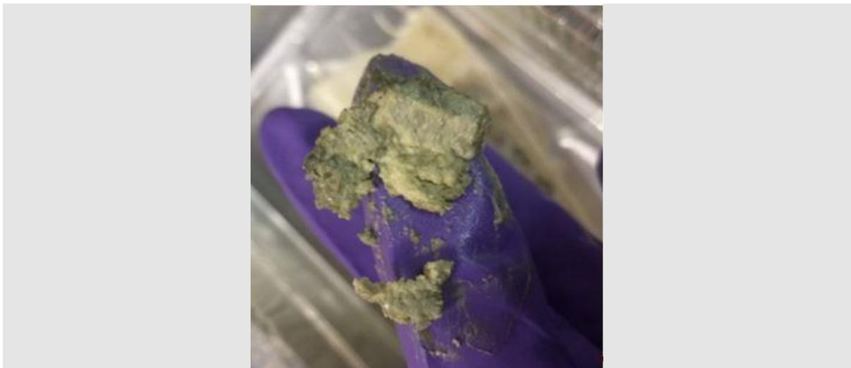
Abbildung 105: Konsistenz der Siloabdeckungsproben nach Batchversuch
