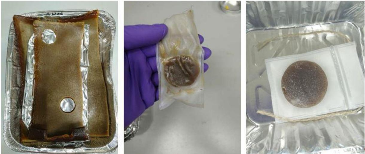
Abbildung 33: *In der Umwelt exponierte und während der Probenaufbereitung bearbeitete Siloabdeckung (links), Probestück im Nylonsäckchen (mittig, rechts), Durchflussversuch*
