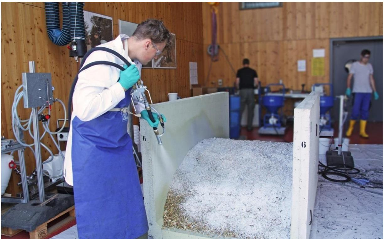
Abbildung 22: Aufspritzen der Siloabdeckung auf die Miniaturesilos mit einem Applikationsgerät der Firma Desoi GmbH mit einer Spritzlanze
