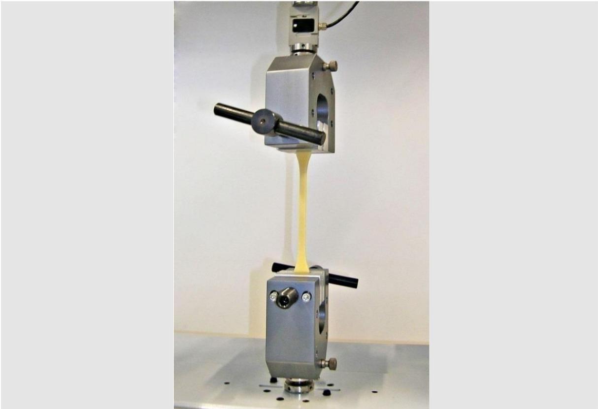
Abbildung 9: *Eingespannter Prüfkörper im Zugprüfgerät*
