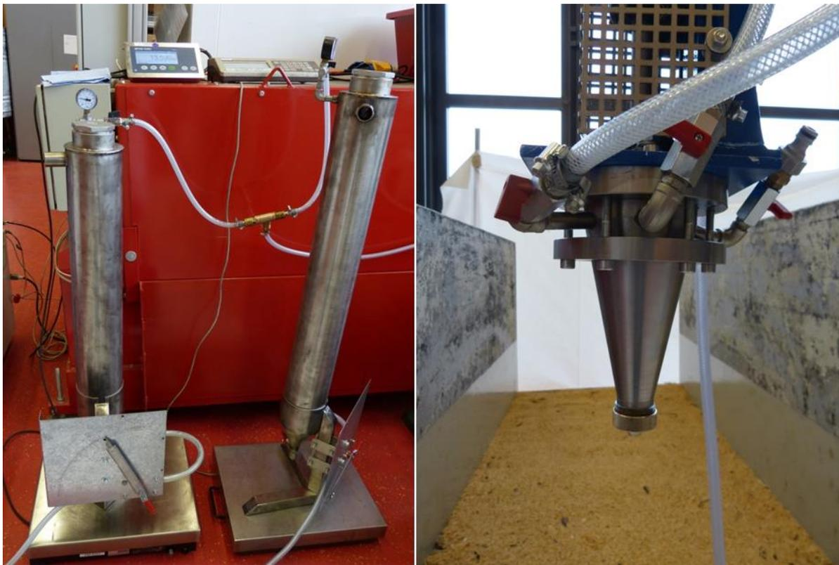
Abbildung 63: Prototyp 1 – links: Druckbehälter für die Komponenten A und B, rechts: Mischkopf mit zwei Anschlüssen für die Komponenten A und B sowie einem Reinigungsanschluss
