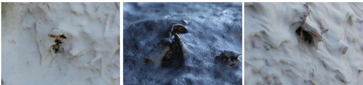
Abbildung 84: Miniatursilos – Versuchsreihe 1 – Löcher im Abdeckmaterial, verursacht durch eine fehlerhafte Applikation in den Silos Nr. 4, Nr. 5 und Nr. 6 (von links nach rechts)
