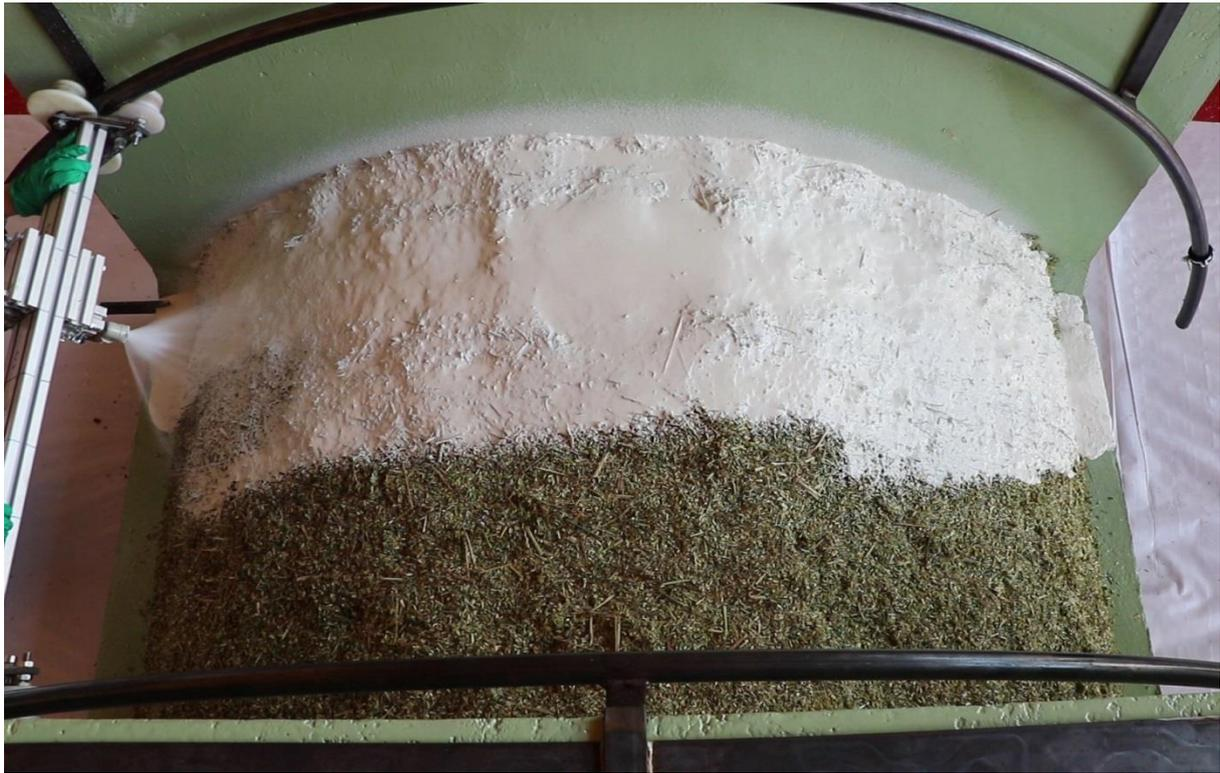
Abbildung 95: Silierversuche mit Miniatursilos – Versuchsreihe 2 – Applikation der Rezepturvariante W20 mit Prototyp 3 des Applikationsgeräts mit Schienenführung der Austragsdüse – Blick von oben
