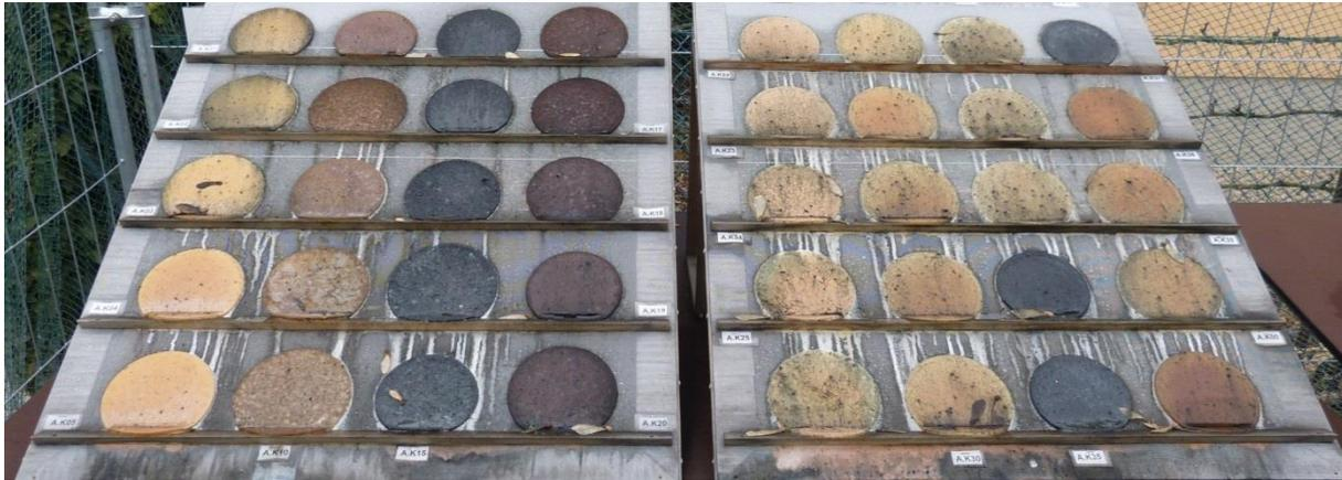
Abbildung 53: Prüfkörper nach sechs Monaten Lagerung im Freien
