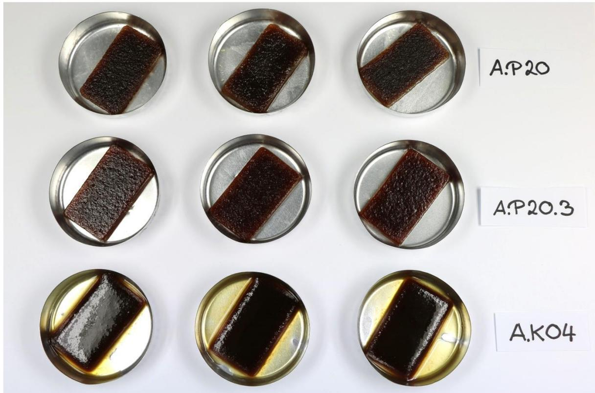
Abbildung 47: Prüfkörper nach sieben Tagen Lagerung bei 80 °C
