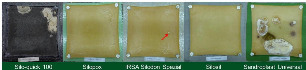
*Abbildung 49: Materialunterseite von Prüfkörpern der Rezeptur A.364 nach fünf Monaten Kontakt mit verschiedenen Siloanstrichen*
