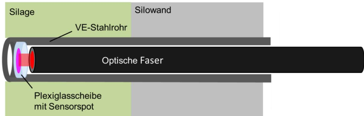
Abbildung 24: Aufbau der Sauerstoffsonden der ersten Generation
