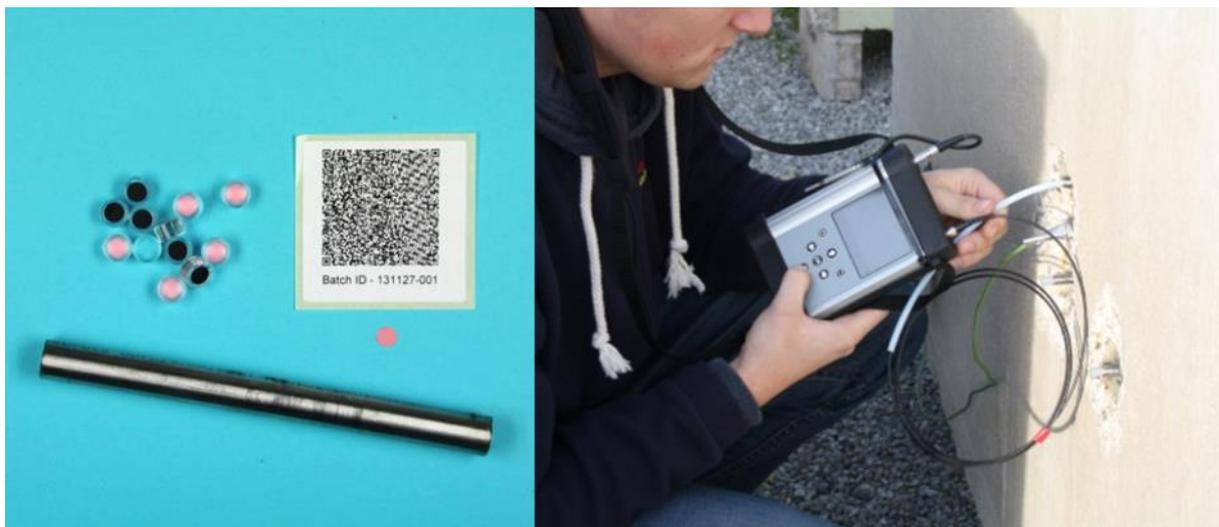
Abbildung 25: Links: Sondenrohr mit auf Plexiglas geklebten O<sub>2</sub>-Spots und Identifizierungscode eines einzelnen Spots; rechts: Sauerstoffmessung mit Glasfaserleiter in der Sonde
