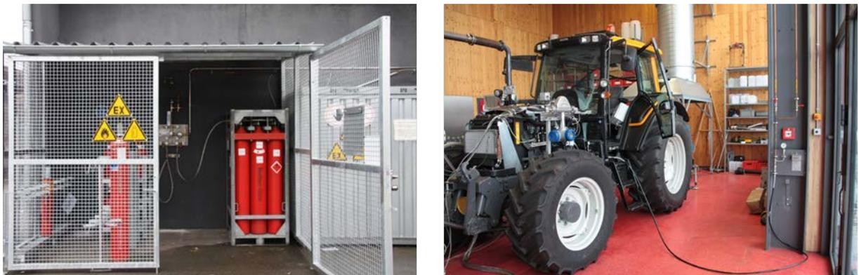
Abbildung 16: Gasversorgungsstation (links); angeschlossener Tankschlauch an den Versuchsschlepper (rechts)
