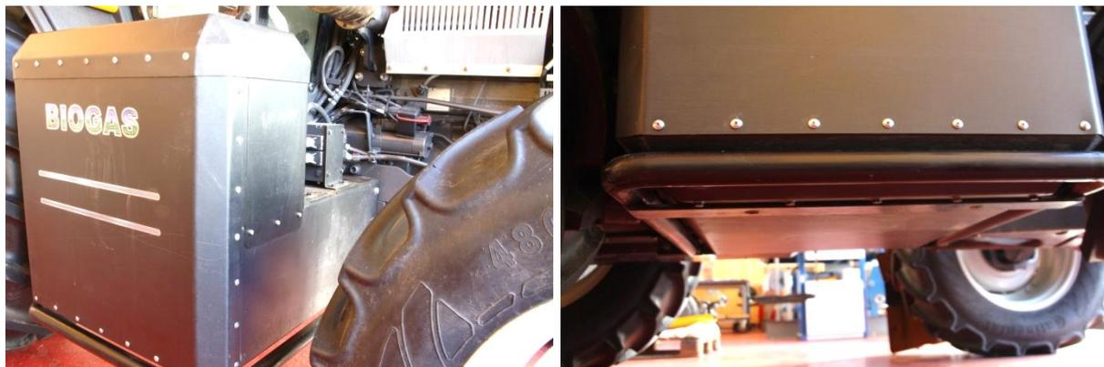
Abbildung 46: Ansicht des Schutzbehältnisses zur Aufbewahrung der Gastanks (links Gesamtansicht; rechts Bodenansicht)
