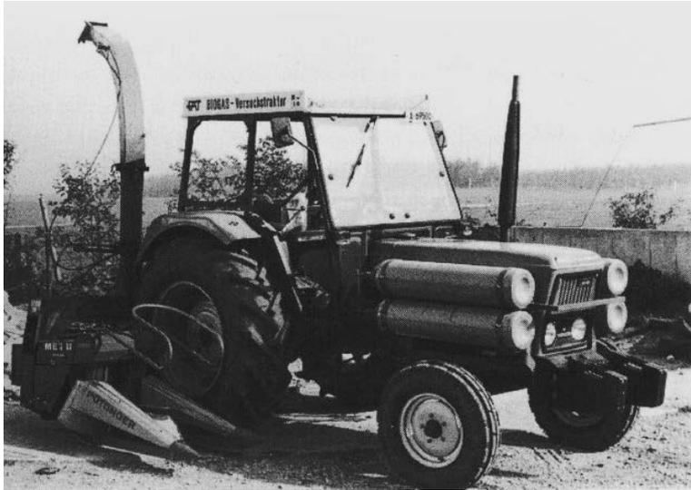
Abbildung 9: Deutz-Fahr 6507 Zündstrahl-Biogastraktor aus FANKHAUSER und MOSER 1983 [38]
