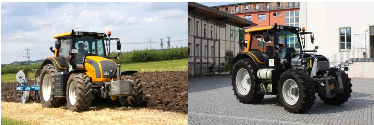
Abbildung 10: Valtra N101 Hi Tech (Dual-Fuel-Traktor); rechts mit abmontierter Verkleidung der Gastanks
