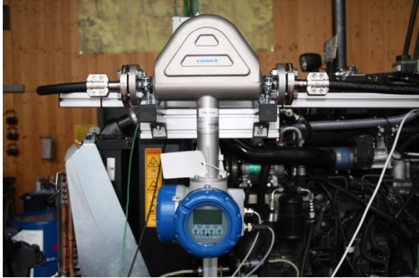
Abbildung 17: Coriolis-Massflowmeter im Prüfstands Aufbau
