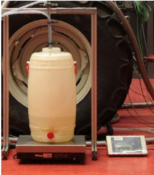
Abbildung 15: Aufbau zur Bestimmung des Kraftstoffverbrauchs mittels Wägung
