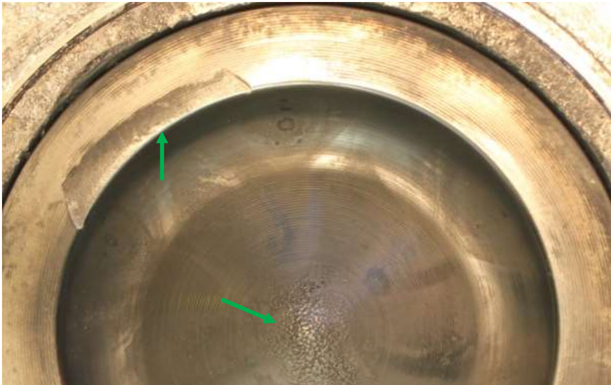
Abbildung 79: Abdrücke bzw. Ablagerung auf der Oberfläche von Kolbenboden Nr. 5 (links oben) und raue Oberfläche in der Kolbenmulde (mittig) am Traktor JD-G
