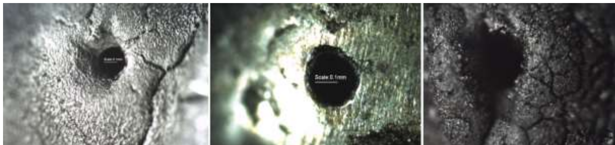
Abbildung 76: Beispiele für unterschiedliche Ablagerungsformationen am Einspritzlochaustritt (Foto: regineering GmbH)
