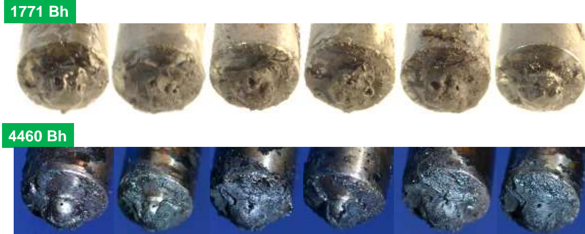
Abbildung 75: Detail Düsenkuppen der Zylinder Nr. 1 bis 6 (v. l. n. r.) bei 1.171 (Foto: TFZ) und 4.460 Betriebsstunden (Foto: regineering GmbH)
