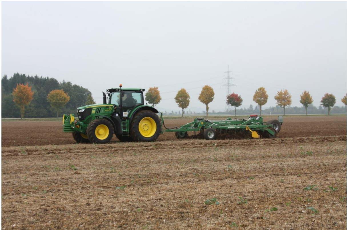
Abbildung 4: Abgasstufe-IV-Traktor im Feldeinsatz auf der Versuchsstation Grub
