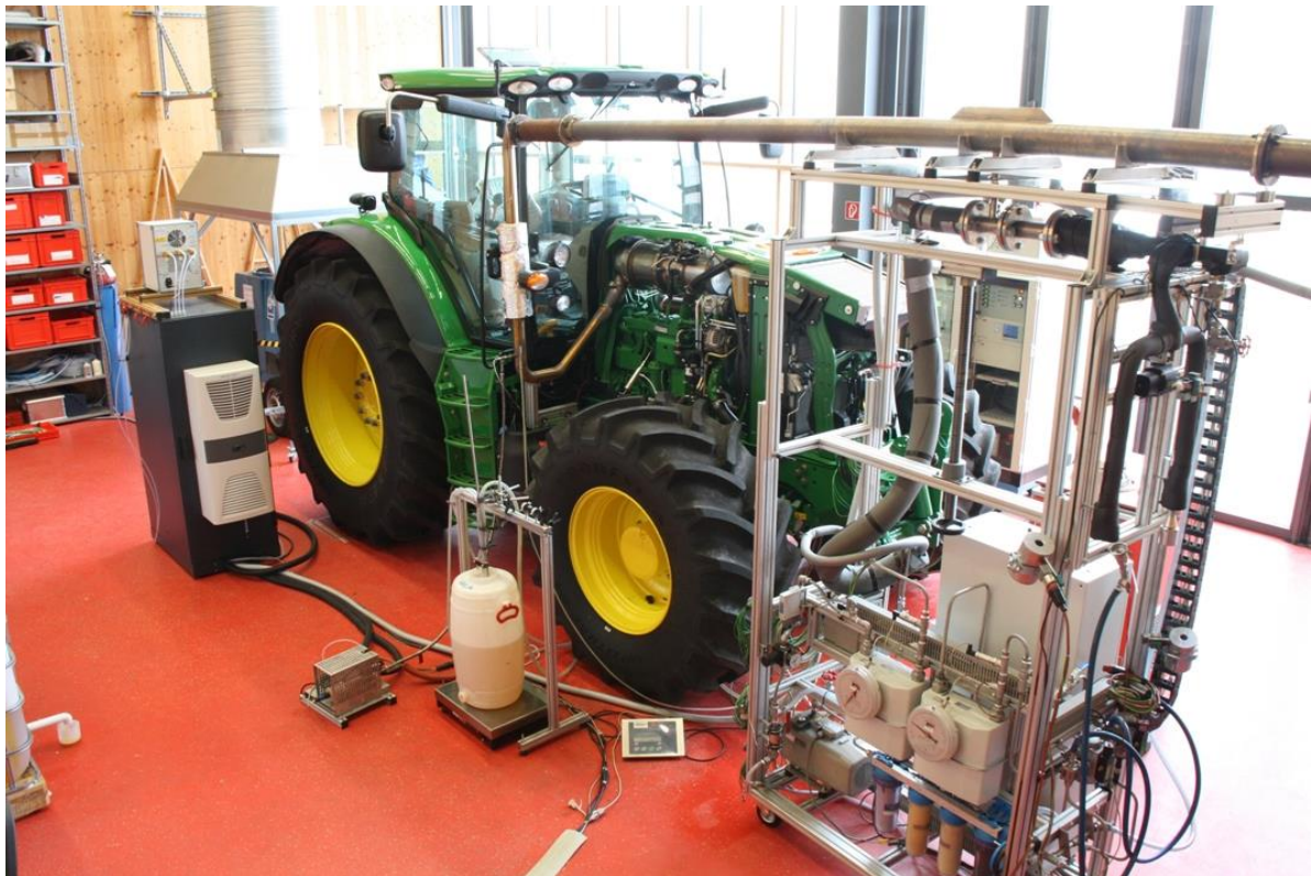
Abbildung 22: Versuchstraktor auf dem TFZ-Traktorenprüfstand (Quelle: TFZ)
