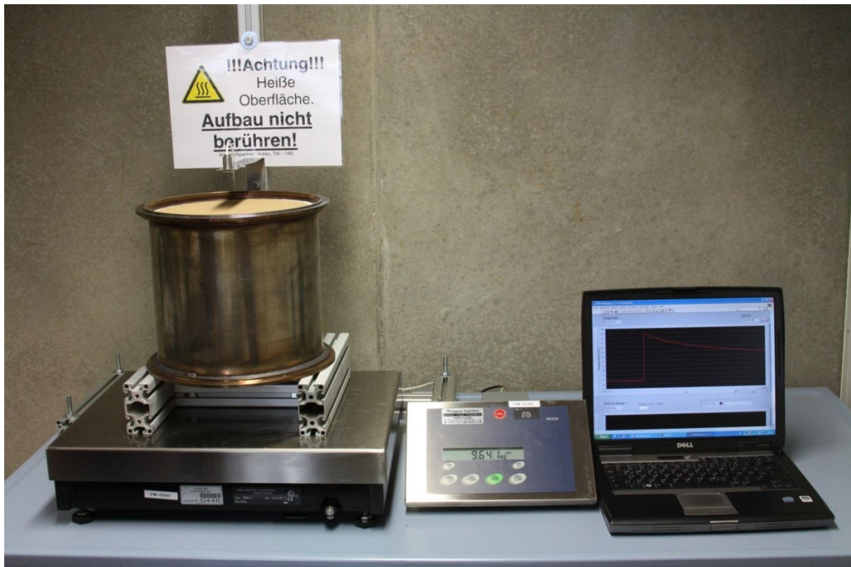
Abbildung 11: Messaufbau zur Bestimmung des Partikelfilterbeladungszustands
