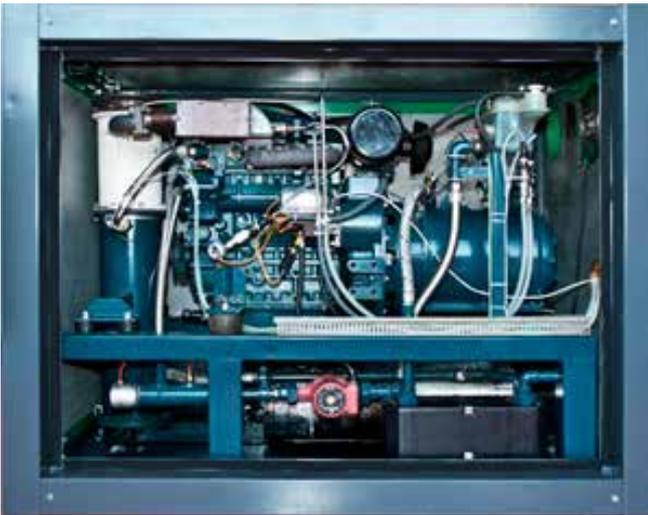
▣ Rapsöl-BHKW, 8 kW elektrische Leistung, Hersteller: KW Energie
