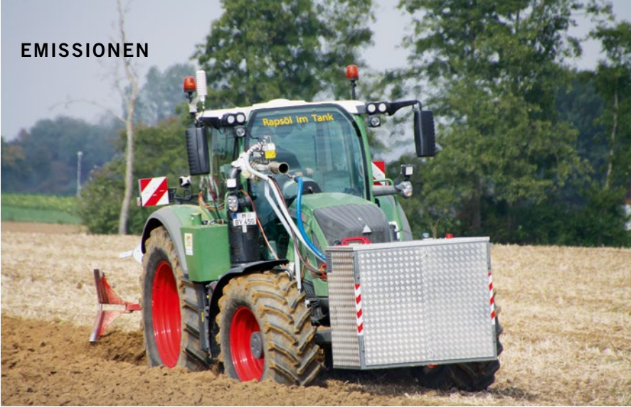
BILD 2 RDE-Messungen mit PEMS am Fendt 724 S4 beim Pflügen (© TFZ)
