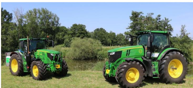
Abbildung 2: MuSt5-Trak-Versuchstraktoren, JD 6135R mit portablen Emissionsmesssystem im Heckanbau (links) und JD 6250R (rechts)
