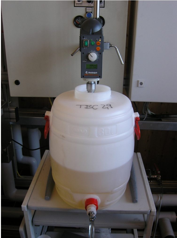
Abbildung 12: Kraftstoffbehälter mit Versuchskraftstoff und Rührwerk
