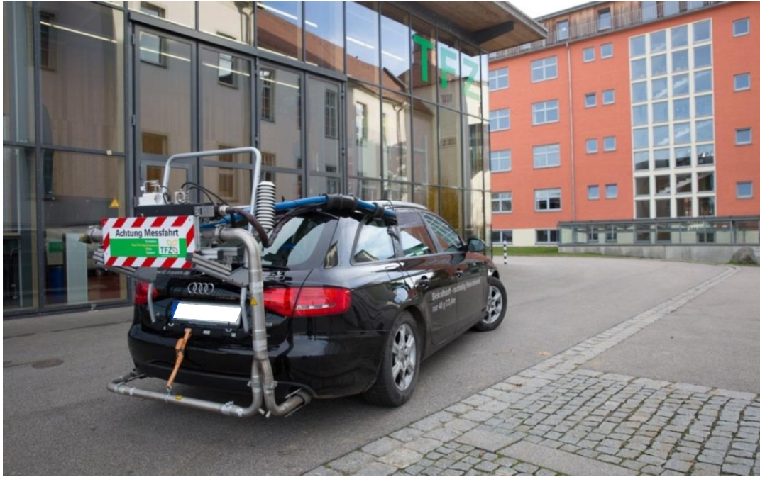
Abbildung 19: Übersicht des Messaufbaus am Fahrzeugheck (Quelle: TFZ)
